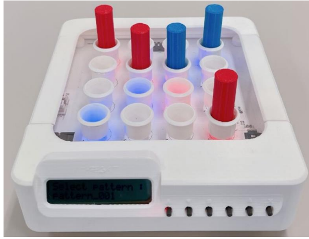
Şekil 1.15: Elektronik Pegboard düzeneği (Okahashi vd., 2023)
