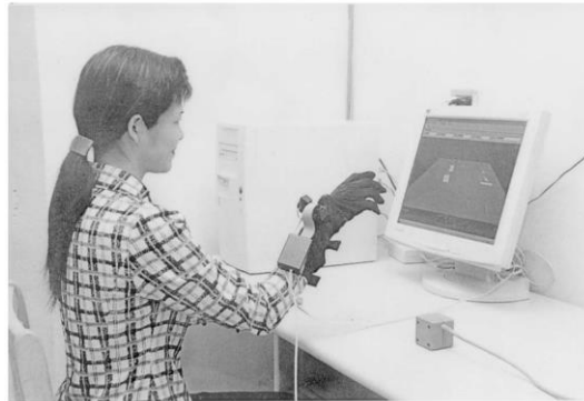
Şekil 1.16: Flex sensör tabanlı sistem (Chuang vd., 2002)
