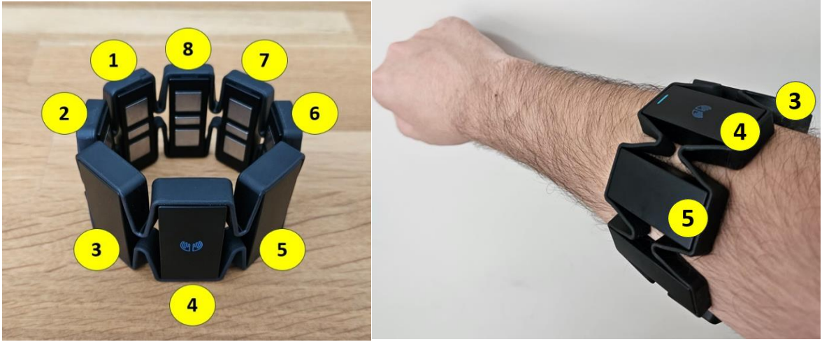
Şekil 2.6: MYO Armband kanal numaraları ve kol üzerinde yerleşimi
