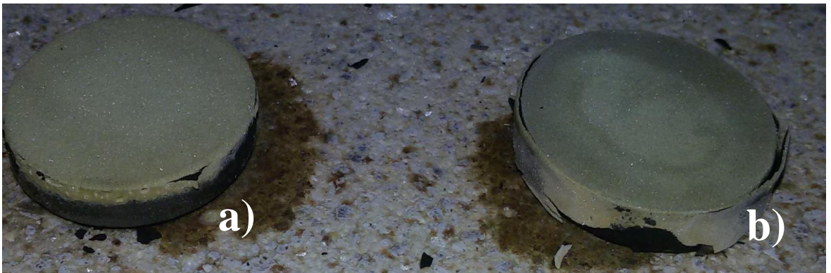
Şekil 31: 1000 °C'de 4 saatlik çevrim sonucunda fırından çıkan numuneler (a) APS üst kaplamalı, (b) EB-PVD üst kaplamalı.
