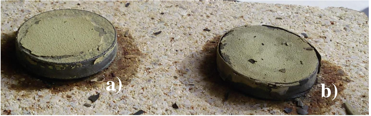
Şekil 33: 1000 °C'de 8 saatlik çevrim sonucunda fırından çıkan numuneler (a) APS üst kaplamalı, (b) EB-PVD üst kaplamalı.
