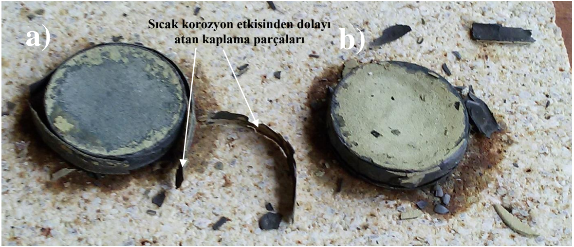
Şekil 35: 1000 °C'de 12 saatlik çevrim sonucunda fırından çıkan numuneler (a) APS üst kaplamalı, (b) EB-PVD üst kaplamalı.
