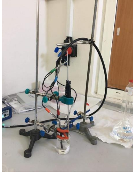
Şekil 3.5: Elektrokimyasal korozyon testi deney düzeneğinin görünümü.
