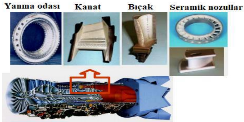
Şekil 2.15: Bir gaz türbininde termal bariyer kaplama uygulanan parçalardan bazıları (URL-8, 2016).
