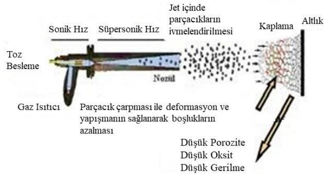
Şekil 2.11: CGDS kaplama yönteminde kaplama oluşumu (URL-6, 2015).
