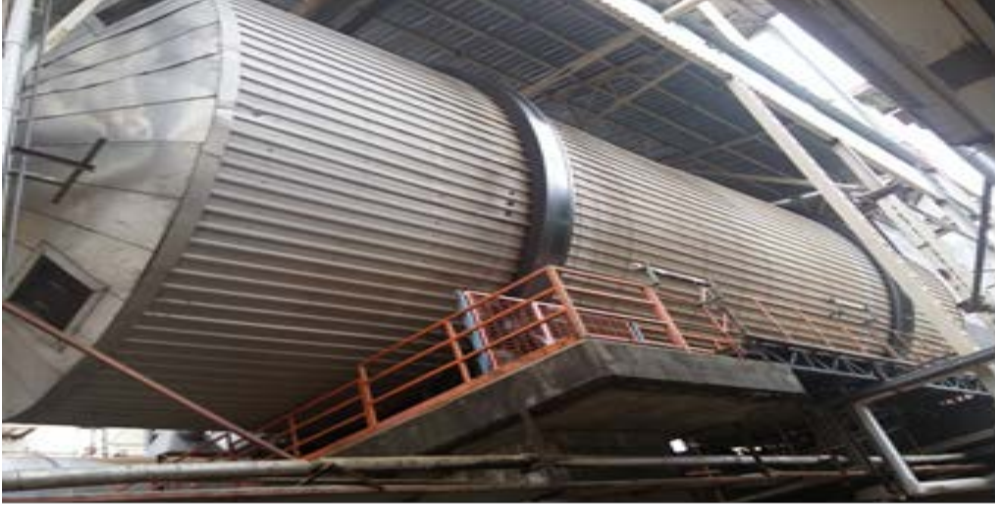
Şekil 11:Döner tamburlu kurutucu.
