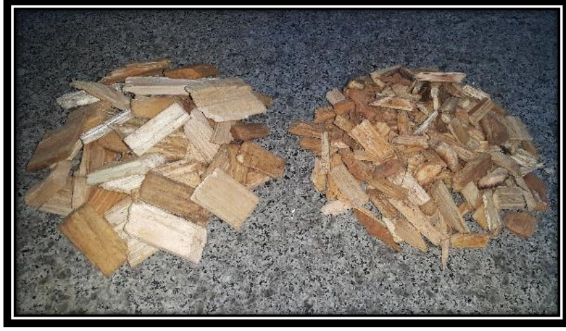
Şekil 2.2: Odun chipslerin macro ve micro görünüşü.
