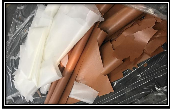
Şekil 1.23: Ham kağıt ve dekor kağıtlarına reçine emdirilmesi işlemi esnasında ortaya çıkan atık kâğıt.
