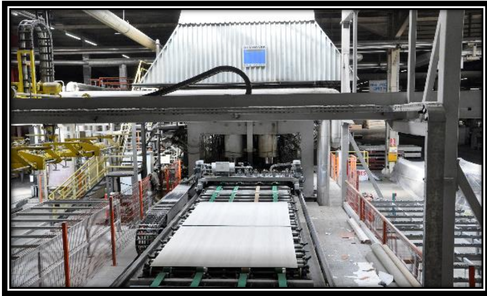
Şekil 1.15: Tek katlı melamin prestenden çıkan levha üzerine kâğıt kaplanmış levha.
