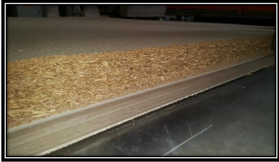
Şekil 2.12: Ön pres çıkışı levha taslak görünümü.
