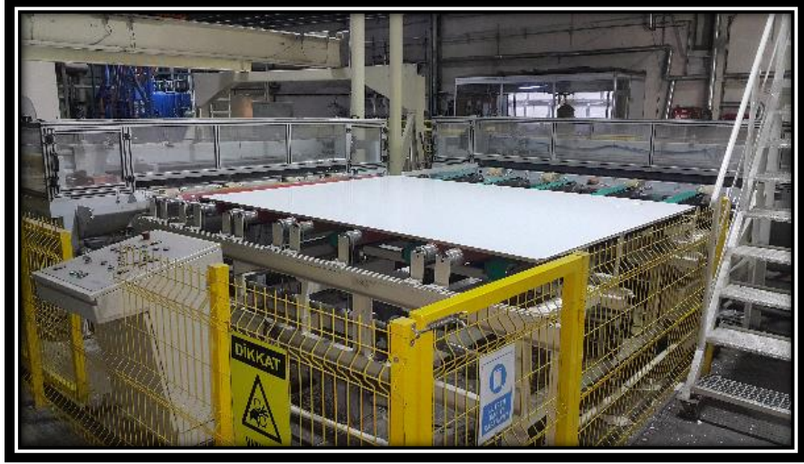
Şekil 1.21: Levha kenarındaki fazla payı kesen ve temizleyen makine.
