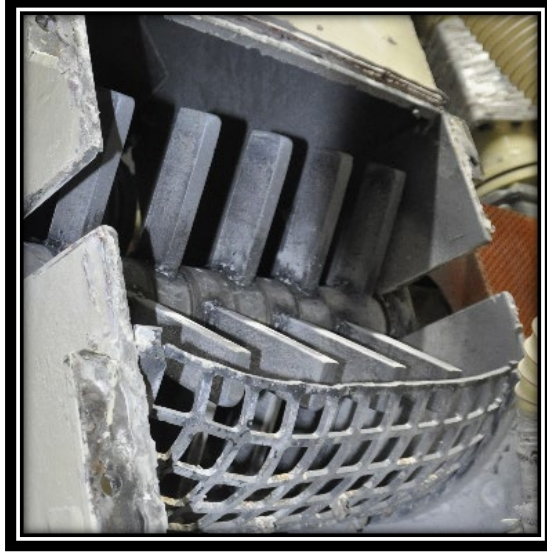
Şekil 1.25: Atık kâğıtların parçalayan makinenin iç görünüşü.
