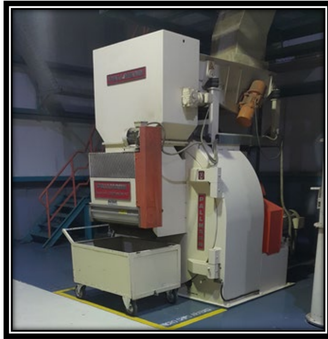
Şekil 1.2: Kaba yongaların inceltilmesinde kullanılan ring.
