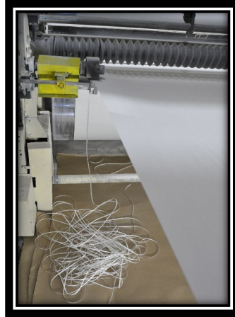
Şekil 1.13: Kesici bıçak yardımıyla fazla kenar payının kesilmesi.
