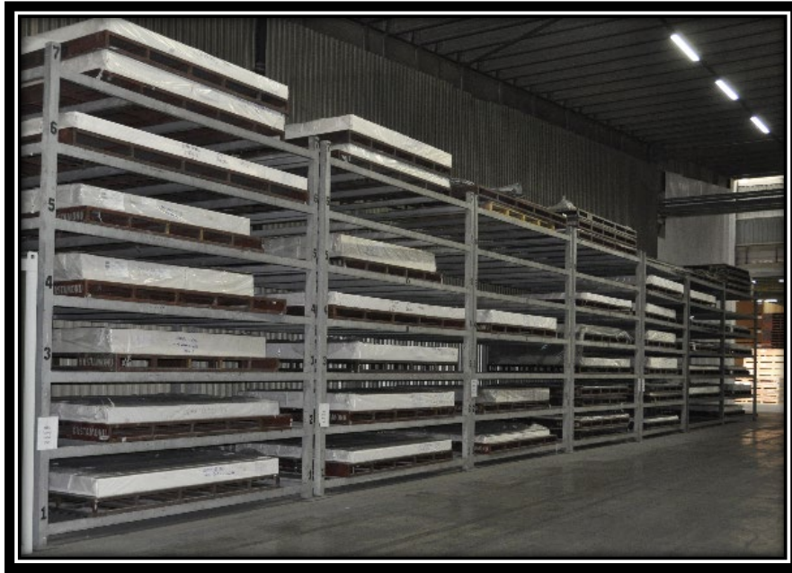
Şekil 1.14: Kâğıtların numaralanmış raf düzeninde ve uygun şartlarda depolanması.
