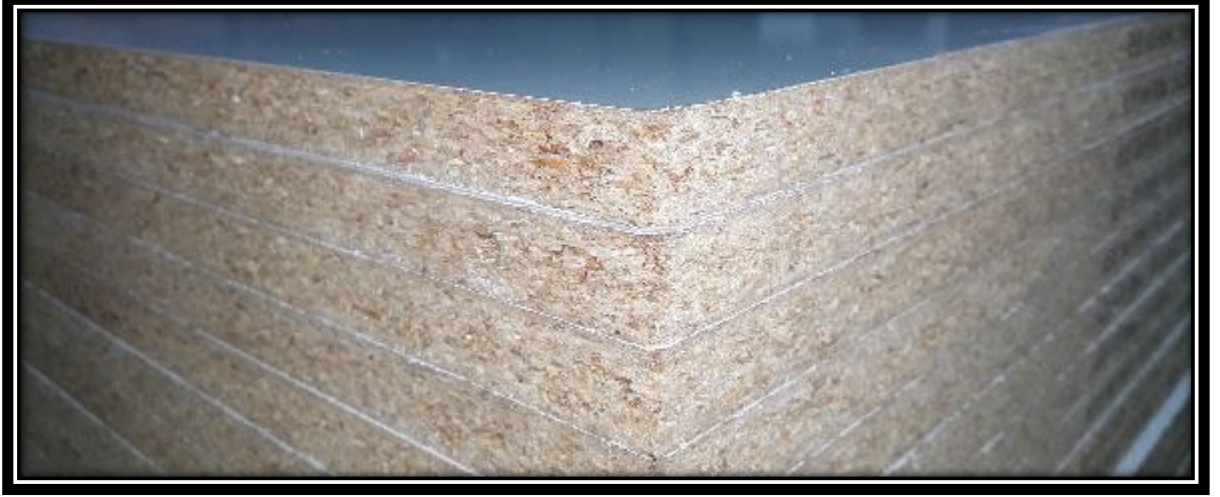
Şekil 1.18: Pres sonrası kenarları temizlenmiş levhanın görünüşü.
