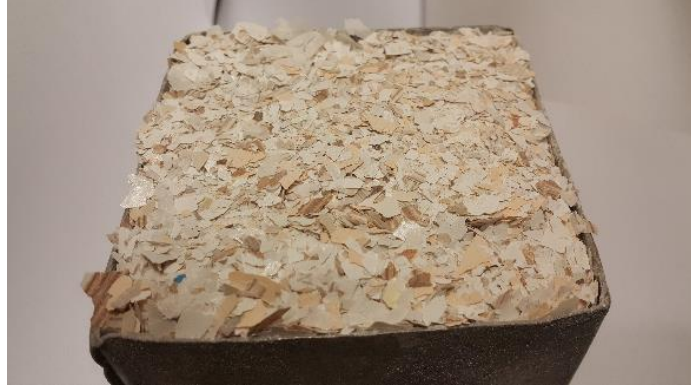
Şekil 1.22: Parçalayıcıdan geçen yeniden kullanıma hazır atık kâğıt.
