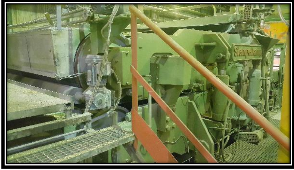
Şekil 2.11: Ön pres (ön pres çıkış görünümü).
