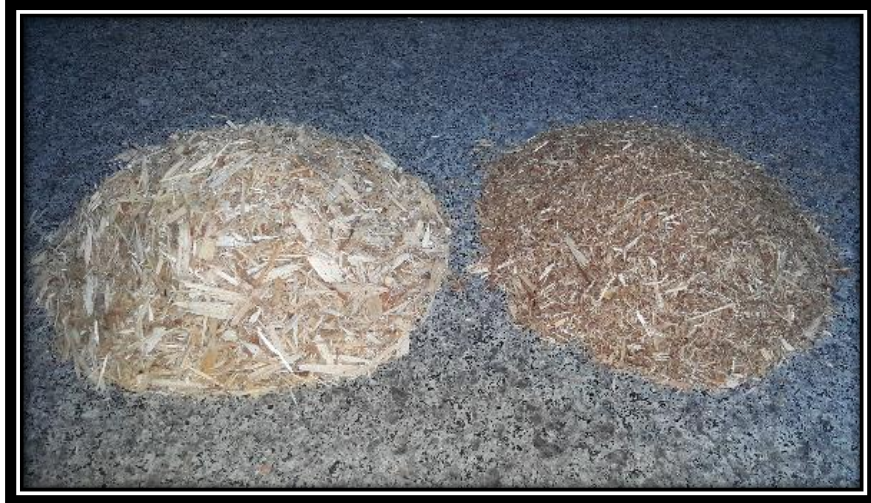
Şekil 2.3: İnceltici değirmenden geçen flake malzeme.
