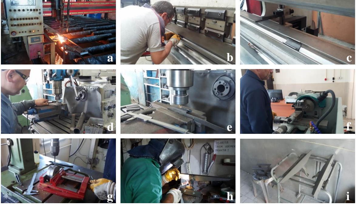
Şekil 24: Açılı katlanır masa mekanizmasının üretim aşamaları.
