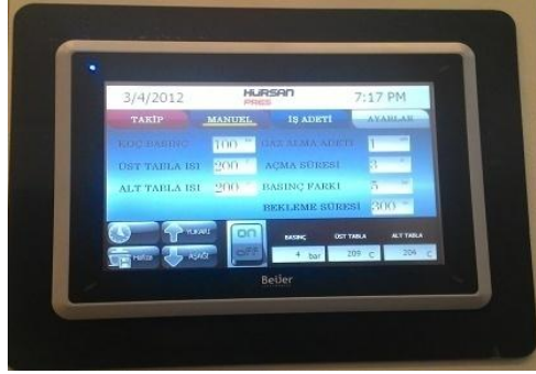
Şekil 13: Sıcak pres makinesinde cihaza girilen değerler.
