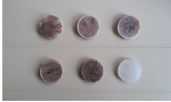
Şekil 21: Isı Geçirgenlik testi için kompozitlerden kesilen numuneler.
