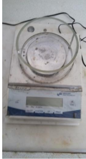
Şekil 11: Çalışmada kullanılan hassas terazi.
