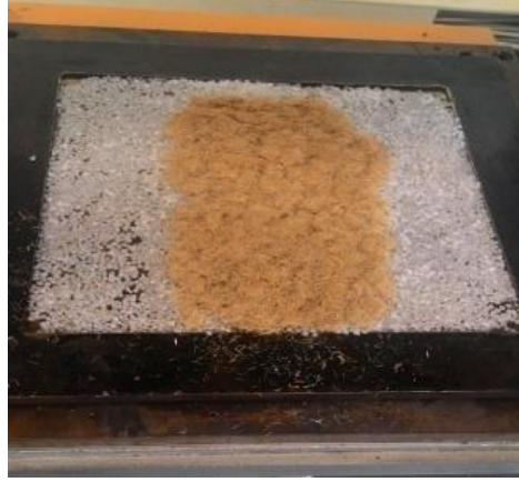
Şekil 16: Kalıp üzerine yerleştirilen meyan kökleri ve polipropilen cipsler.
