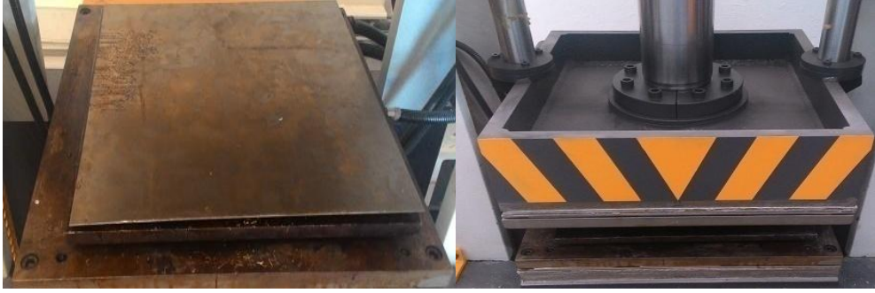
Şekil 18: Üretim esnasında kompozit malzemelerin basılması.
