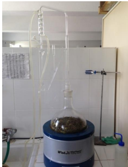
Şekil 24: Uçucu yağ eldesinde kullanılan Klevenger aparatı (Fotoğraf: Mehmet KURTÇA, 2017).
