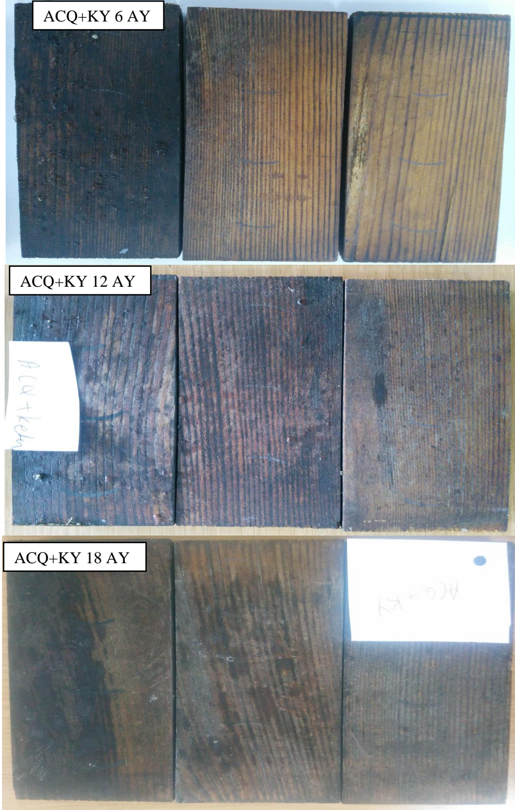
EK Ç: 6-12-18 ay dış ortam koşullarında beklemiş ACQ+KY emprenyeli örneklere ait görüntüler.
