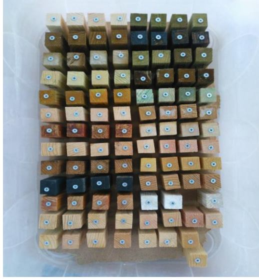
Şekil 24: Odun örneklerine çakılmış vidalar.
