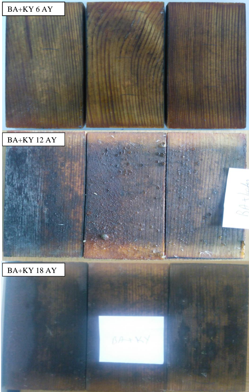
EK K: 6-12-18 ay dış ortam koşullarında beklemiş BA+KY emprenyeli örneklere ait görüntüler.
