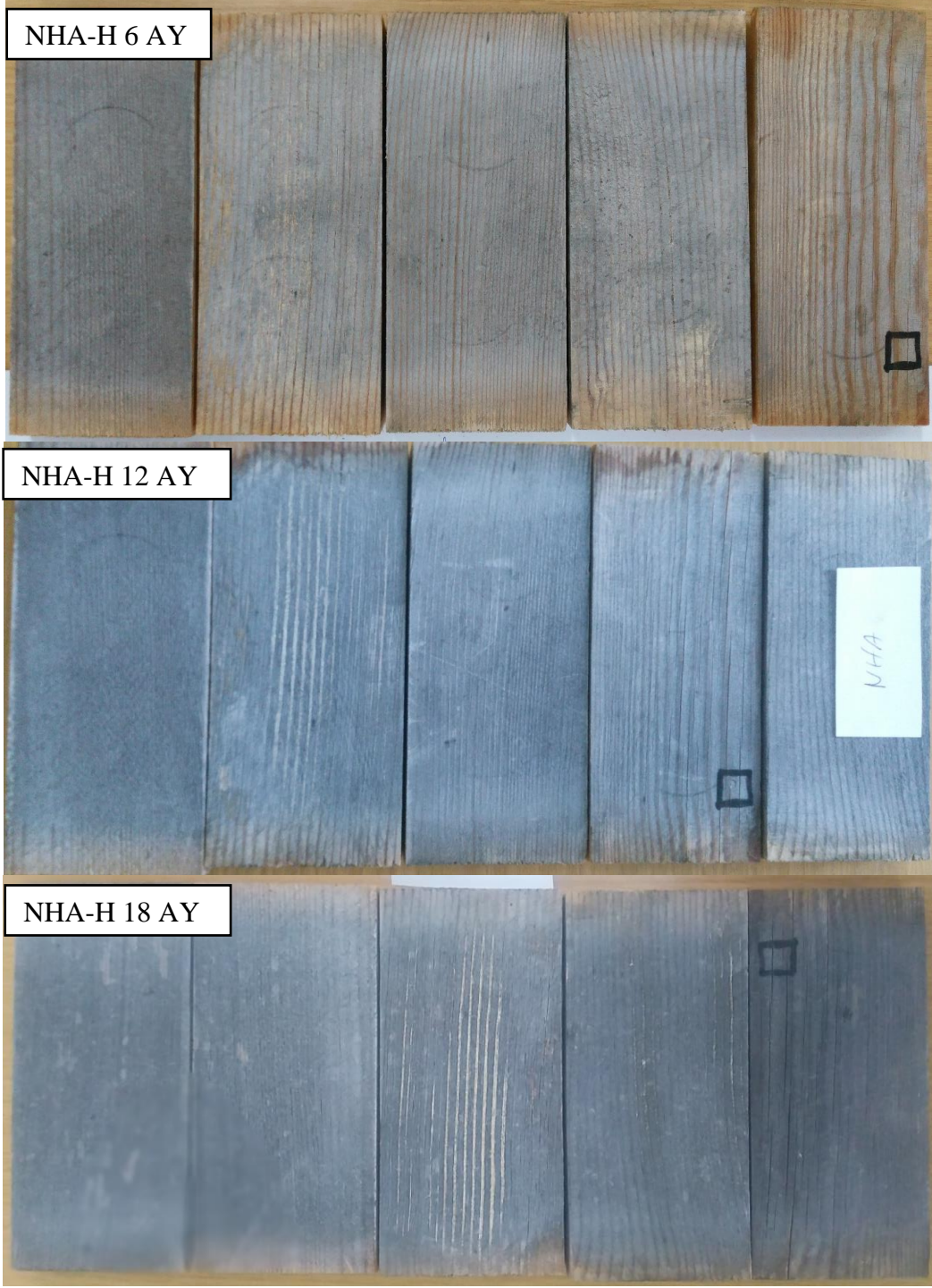
EK V: 6-12-18 ay dış ortam koşullarında beklemiş NHA-H emprenyeli örneklere ait görüntüler.
