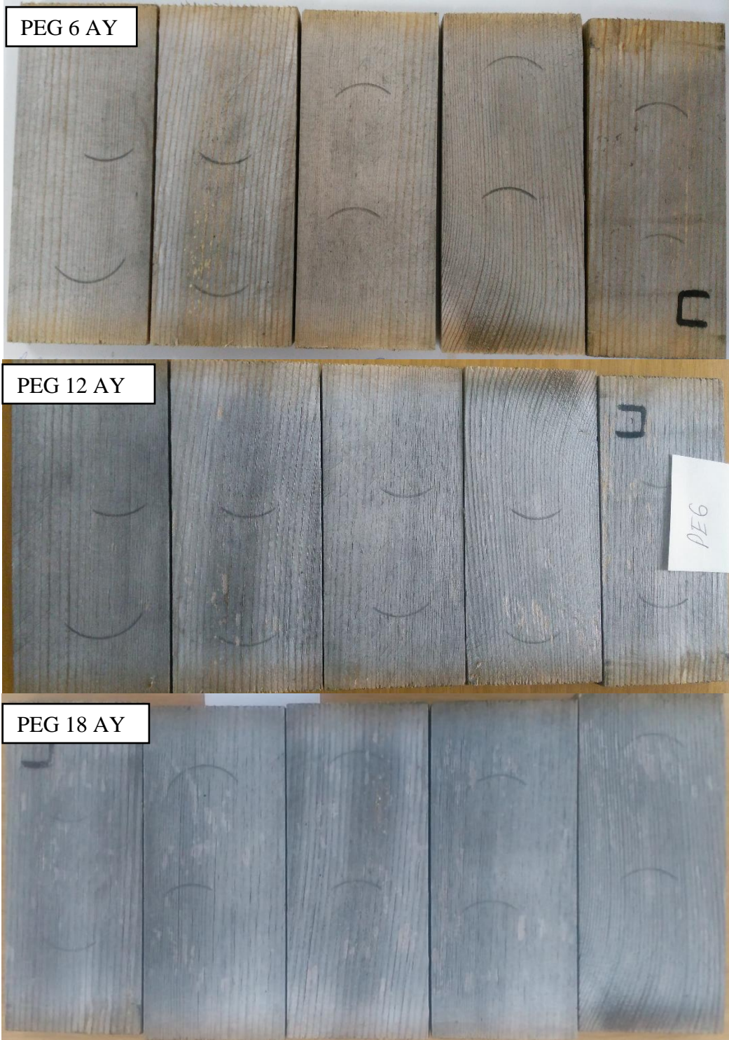
EK T: 6-12-18 ay dış ortam koşullarında beklemiş PEG emprenyeli örneklere ait görüntüler.
