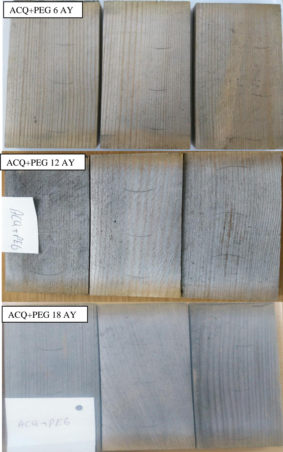
EK E: 6-12-18 ay dış ortam koşullarında beklemiş ACQ+PEG emprenyeli örneklere ait görüntüler.
