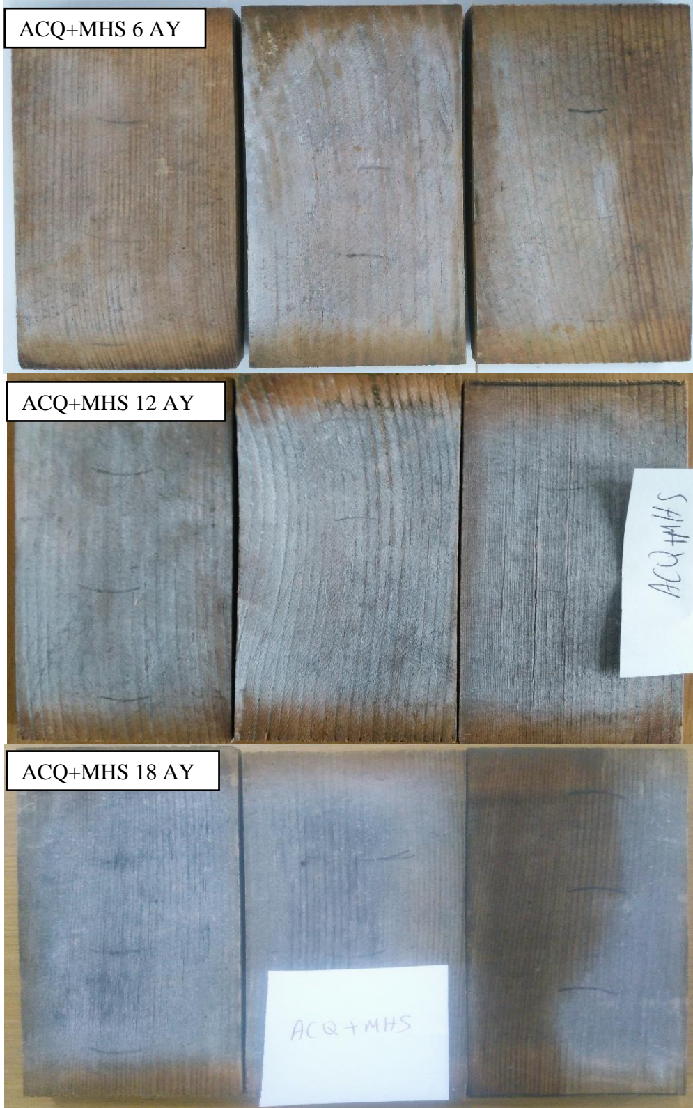
EK G: 6-12-18 ay dış ortam koşullarında beklemiş ACQ+MHS emprenyeli örneklere ait görüntüler.
