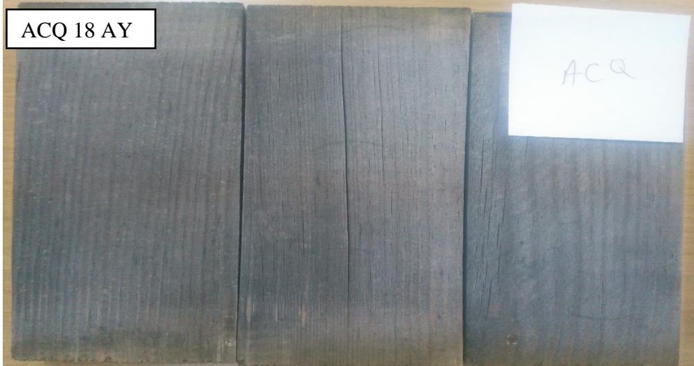
EK B: 6-12-18 ay dış ortam koşullarında beklemiş ACQ emprenyeli örneklere ait görüntüler.
