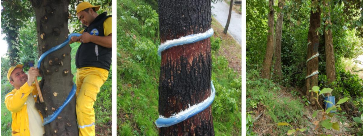
Şekil 2.4: Gövdeden akış ölçümü için ağaç gövdelerinin hazırlanması.
