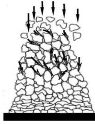
Şekil 2.14: CGDS prosesinde arkadan gelen parçacıkların neden olduğu deformasyon süreci (Van Steenkiste, vd., 2002).
