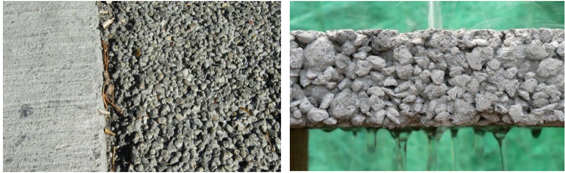
Şekil 2.11: Geçirimli rijit (beton) kaplama ve geleneksel beton kaplama yüzey görünümü (URL-12, 2018).
