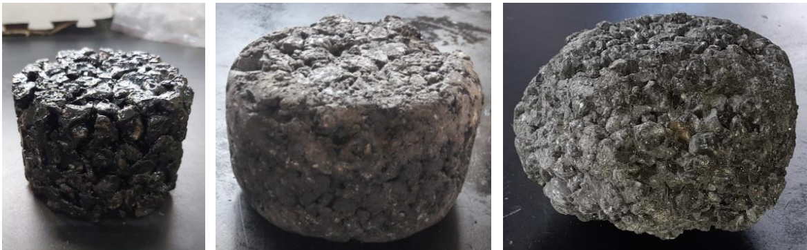
Şekil 5.12: Cantabro aşınma deney öncesi ve sonrası numune örnekleri.
