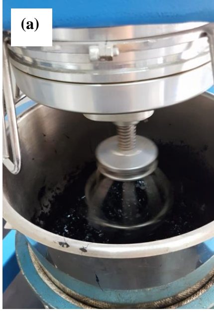
Şekil 5.7: Geçirimli asfalt karışımların hazırlanma aşamaları. a. mikser ile karıştırılması, b. Marshall tokmağı ile sıkıştırılması.
