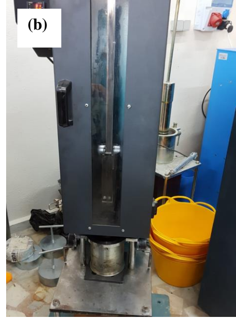
Şekil 5.7: Geçirimli asfalt karışımların hazırlanma aşamaları. a. mikser ile karıştırılması, b. Marshall tokmağı ile sıkıştırılması.
