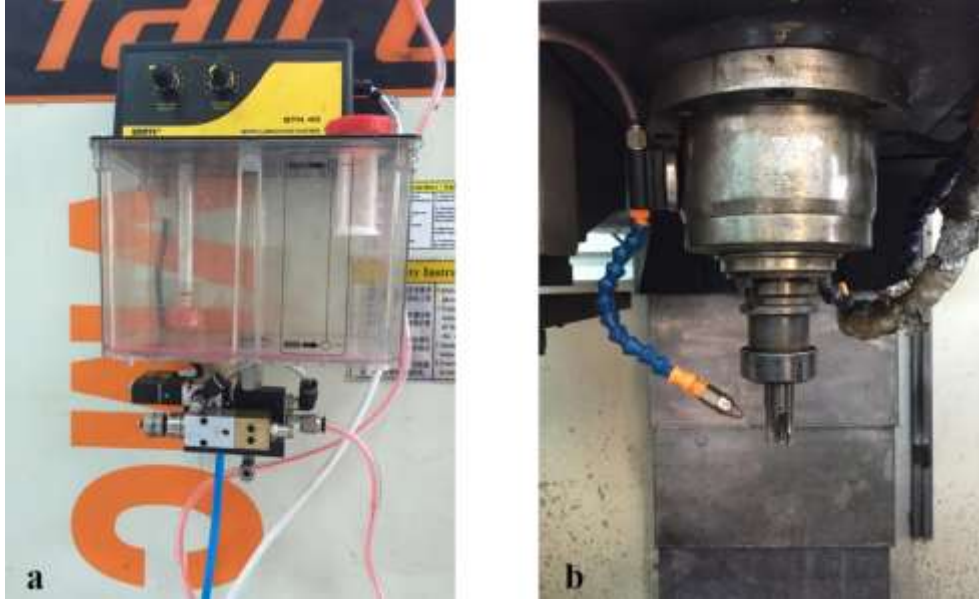
Şekil 3.8: Werte Mikro STN 25 (a) ve MQL nozzle (b)
