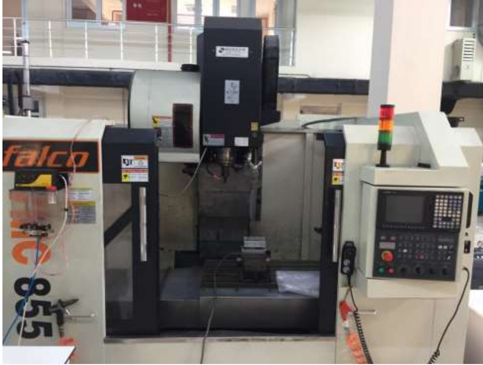
Şekil 3.7: Eksenli FALCO VMC 855-B CNC dikey freze
