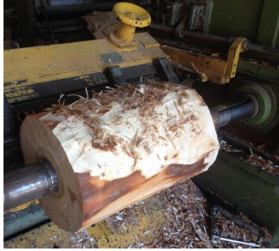
Şekil 2.2: Milli kaplama soyma makinesi.
