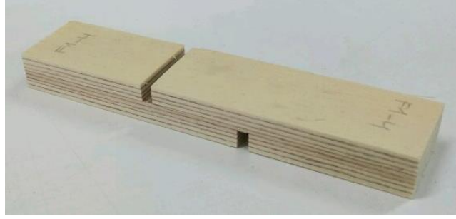
Şekil 3.10: yTKK çekme makaslama direnci test numunesi.
