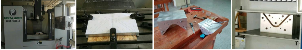
Şekil 4.1: Bükme pres kalıbının üretimi ve montajı.
