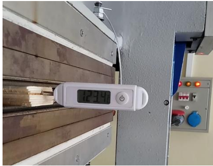
Şekil 3.1: Kaplama katmanlarının içinde sıcaklık yayılımının ölçümü.
