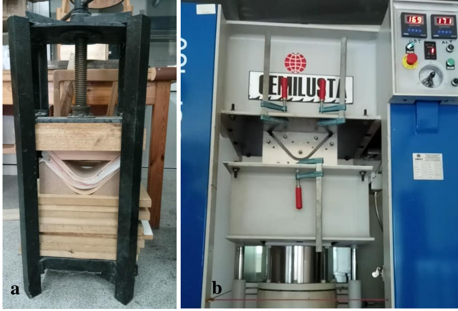
Şekil 4.4: byTKK üretiminde kullanılan a) soğuk, vidalı ön pres makinesi, b) sıcak hidrolik bükme pres makinesi.
