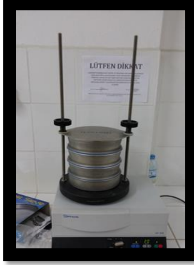
Şekil 3.4: Laboratuvar tipi sarsıntılı elek (Fotoğraf: Ülkü Burcu GİTTİ, 2018).
