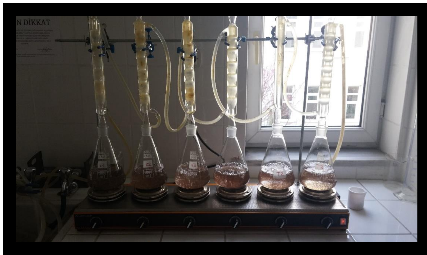
Şekil 3.5: Lignin deneyi (Fotoğraf: Ülkü Burcu GİTTİ, 2018).
