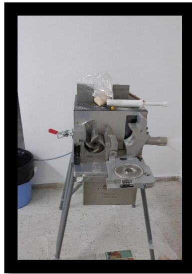
Şekil 3.3: Laboratuvar tipi Willey değirmeni (Fotoğraf: Ülkü Burcu GİTTİ, 2018).
