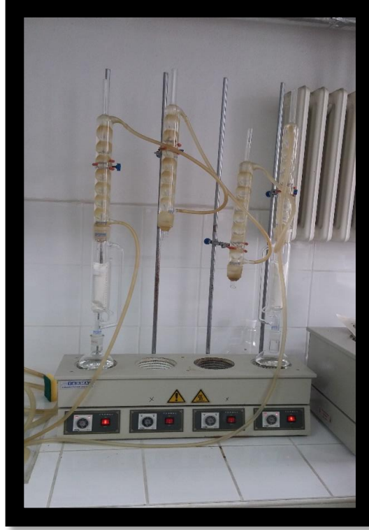
Şekil 3.6: Soxhlet ekstraksiyon cihazı (Fotoğraf: Ülkü Burcu GİTTİ, 2018).
