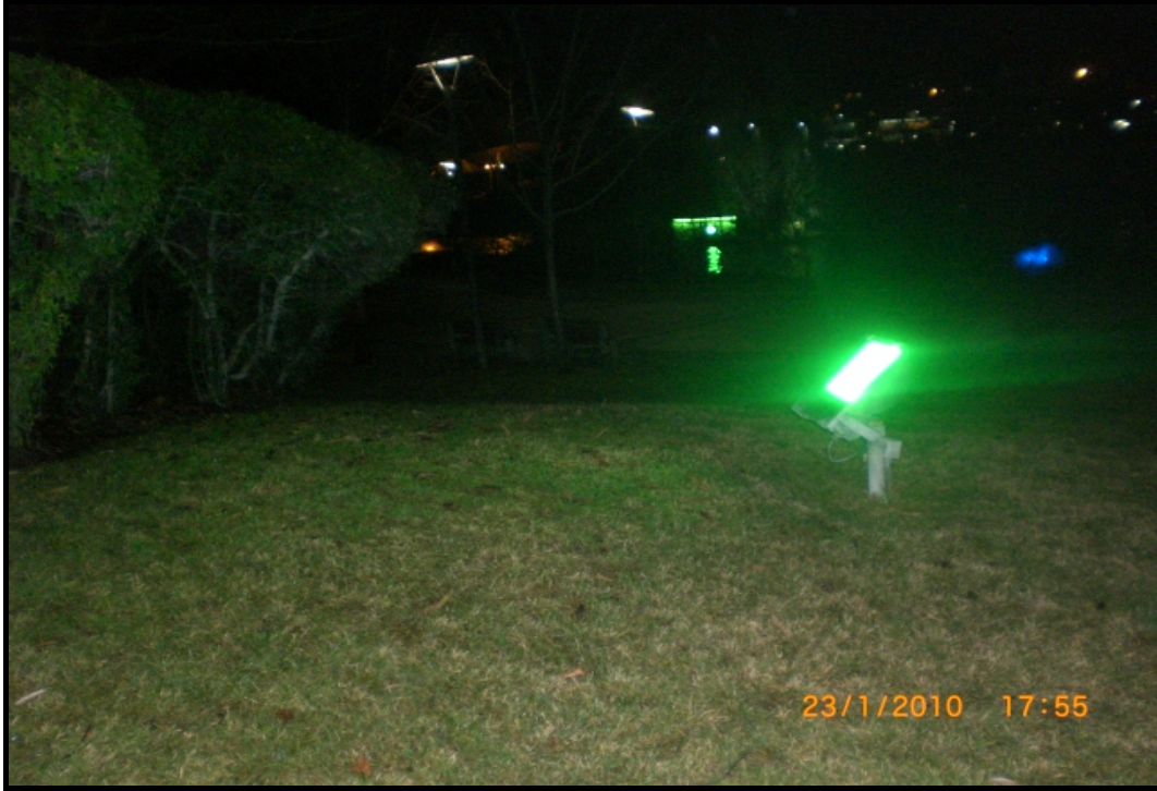
Şekil 5.3 Altınpark'taki projektörlerden kaynaklanan kamaşma problemi örneği (Fotoğraf: Fatih Yenioğlu 2009).
