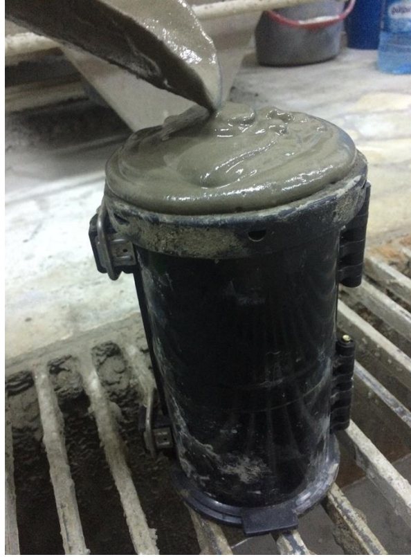
Şekil 3.13: Silindir kalıba yerleştirilen köpük beton harcı.
