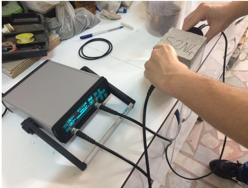
Şekil 3.22: Ultrases geçiş hızı deneyi.
