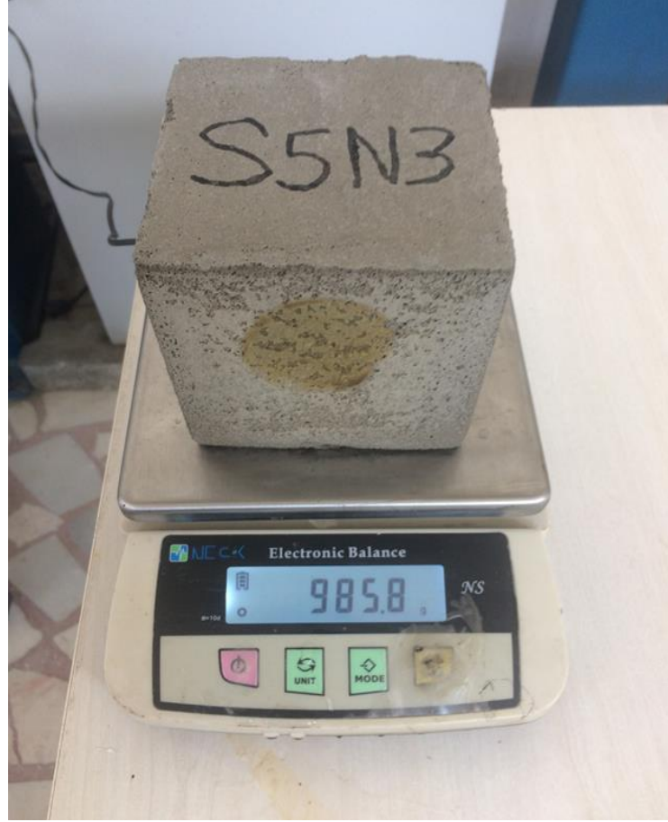
Şekil 3.21: Suya doygun haliyle hassas terazide tartılan numune.
