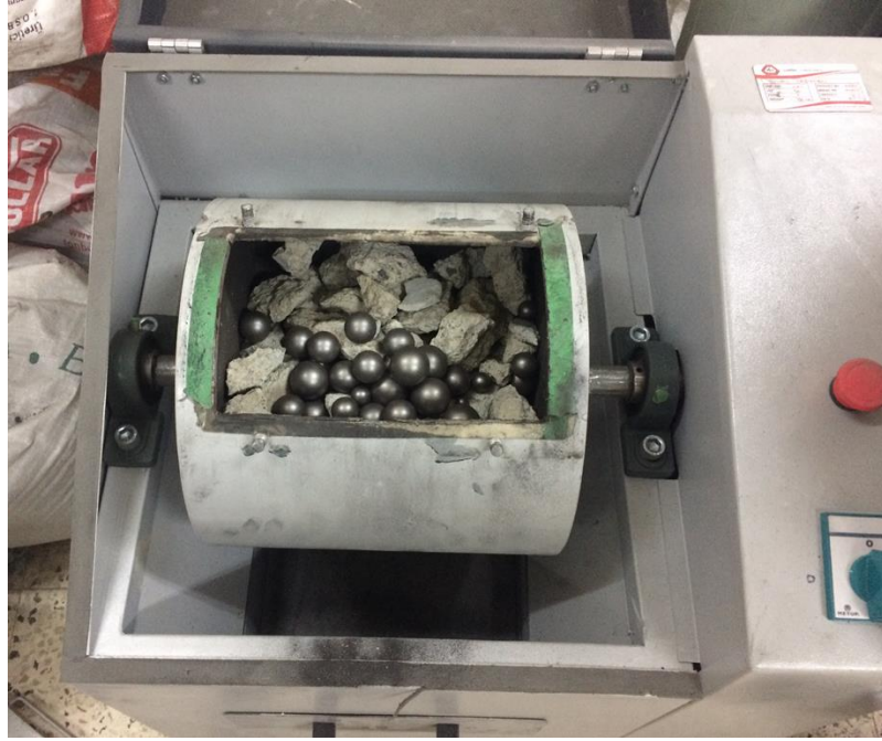
Şekil 3.3: Bilyeli değirmene yerleştirilmiş beton parçaları.
