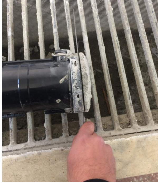
Şekil 3.14: Testereyle üst yüzey fazlalığı kesilen köpük beton.
