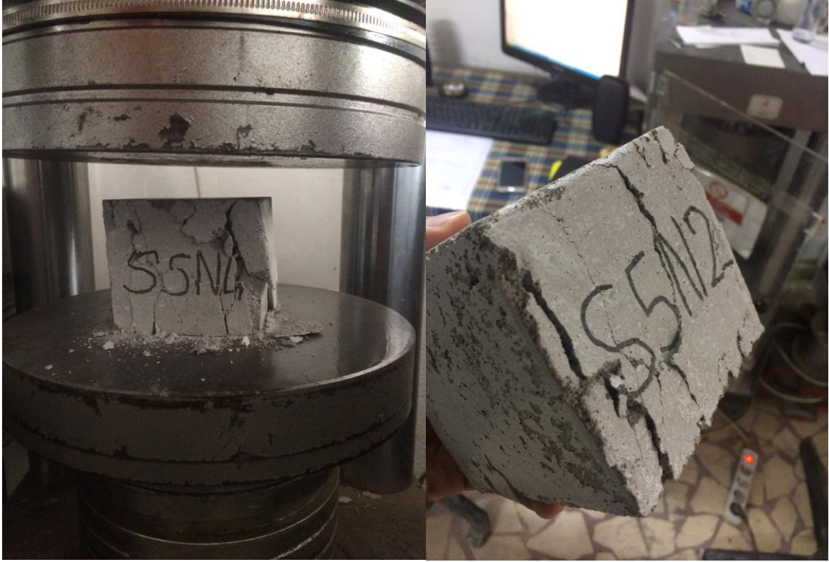
a. S 5 N 4 kırılma şekli.
