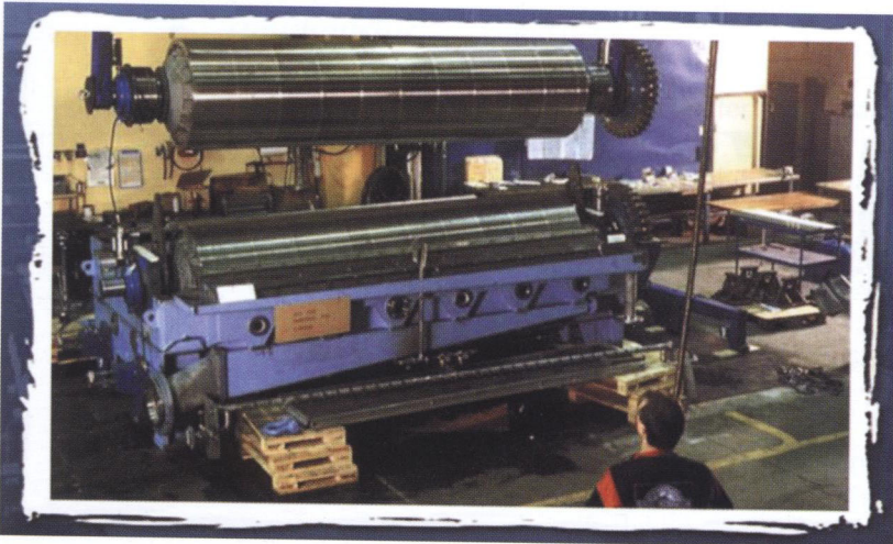
Şekil 4. Yaş preslemede kullanılan yivli pres (4).
