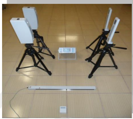
Şekil 23: İki kapılı fotosel düzeneği.
