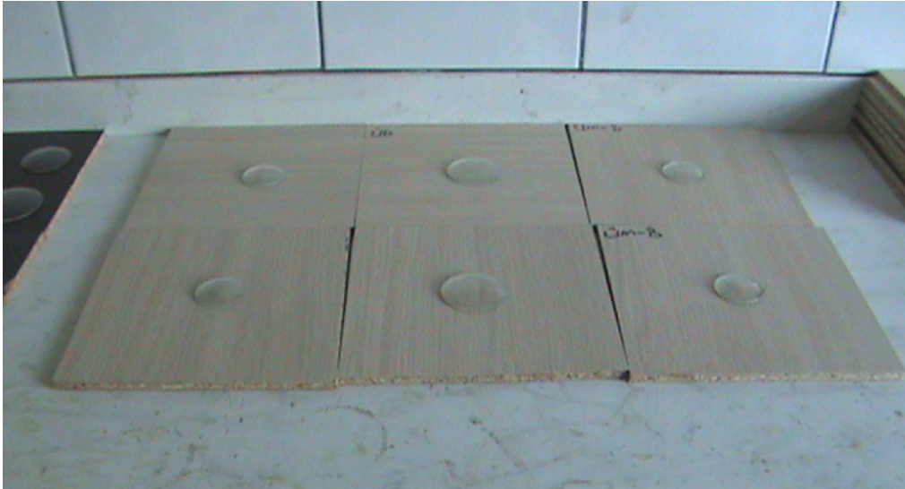
Şekil 2.5 Lekelenmeye karşı mukavemet deneyi.
