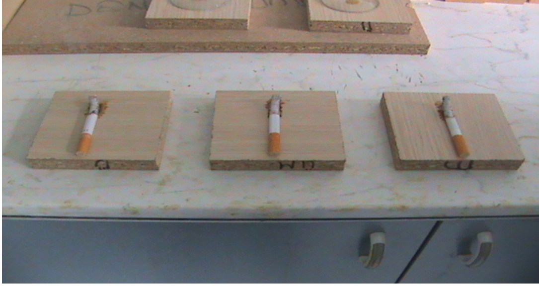
Şekil 2.3 Sigara ateşine mukavemet deneyi.
