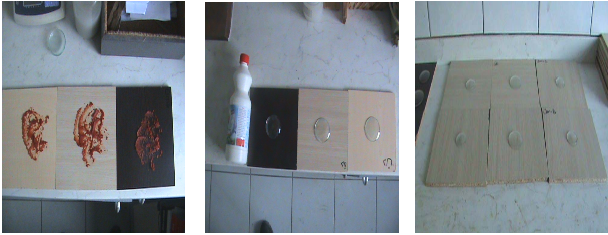
Şekil 2.23 Lekelenmeye mukavemet test düzeneği ( salça – çamaşır suyu - aseton)
