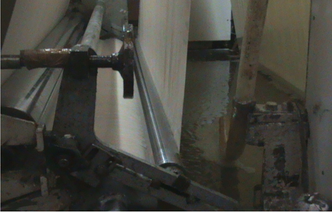
Şekil 1.6 Dekor kağıtlarının empenye edilmesi.
