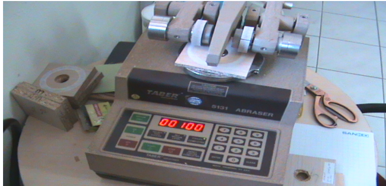
Şekil 2.19 Aşınma deney düzeneği (Taber test cihazı).
