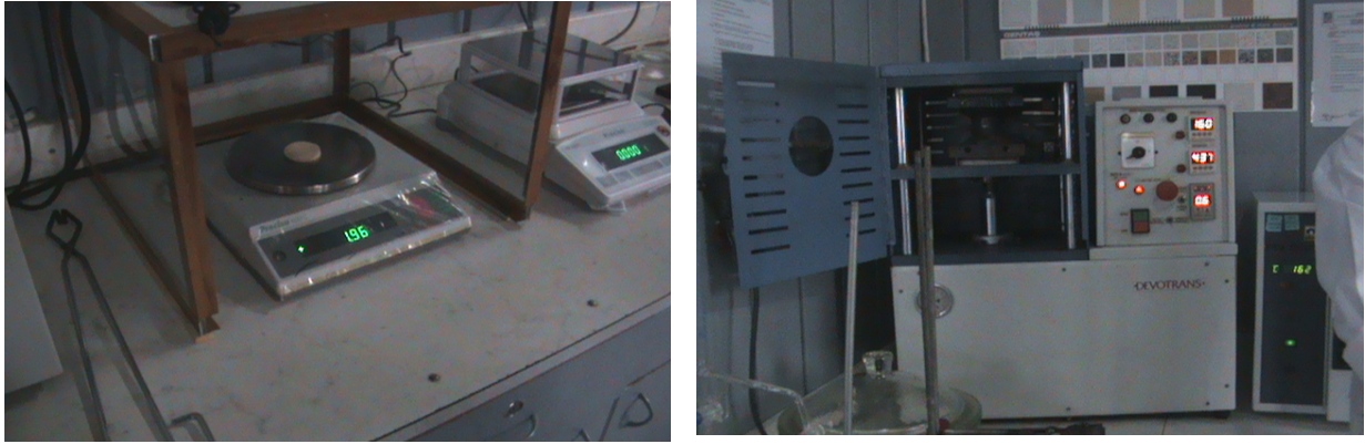
řekil 2.13 Akışkanlık deneyinin yapımında kullanılan pres ve hassas terazi dzenegi.
