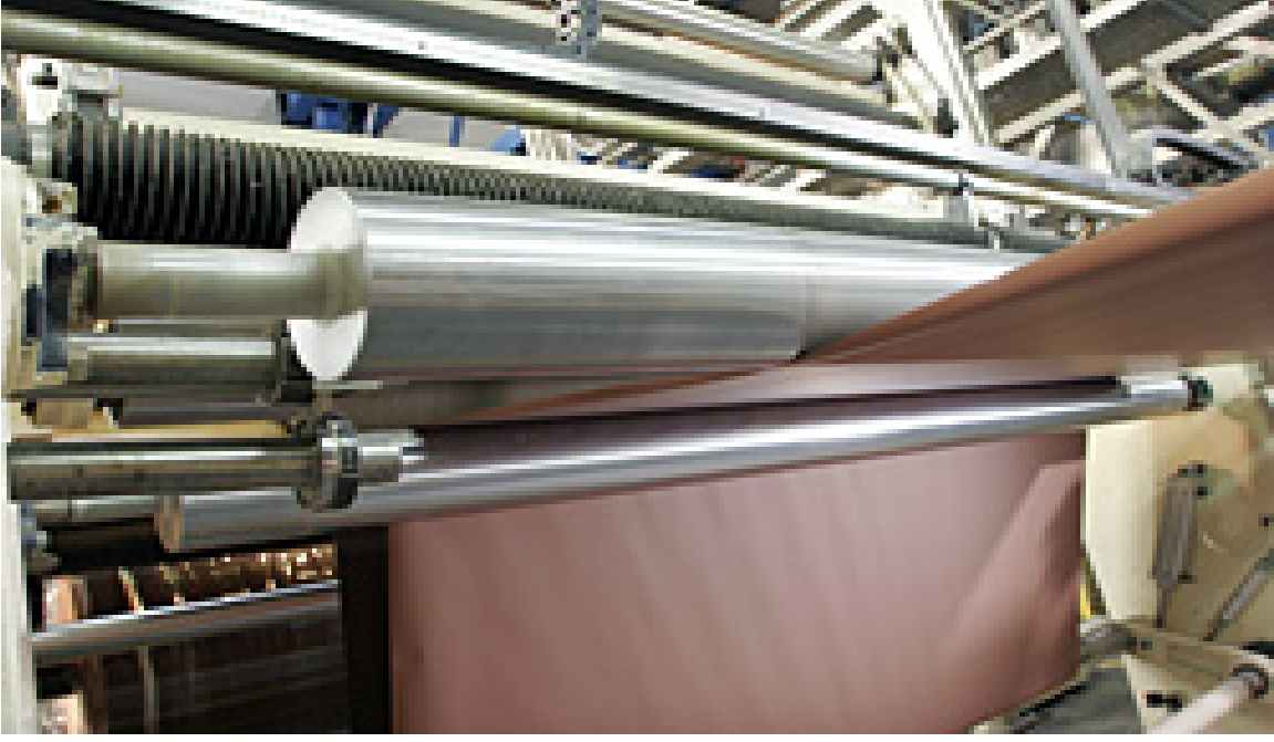
Şekil 1.7 Emprenyeli dekor kağıtların yüzey düzgünlüğünün sağlanması.
