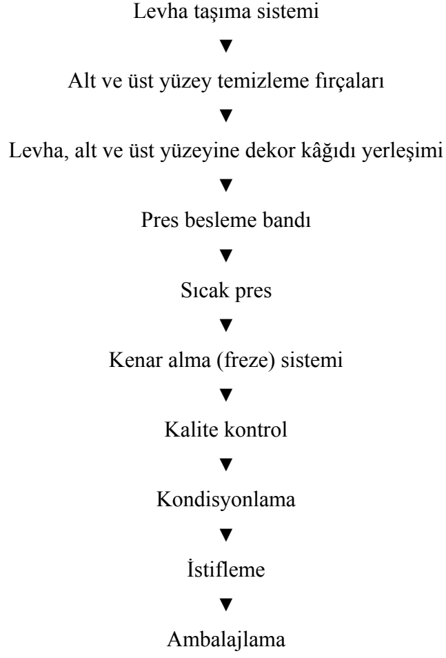
Şekil 1.13 Dekor kâğıtlarının levha yüzeyine kaplama iş akış şeması.
