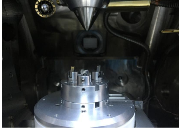
Şekil 42: Kesici takımların taramalı elektron mikroskobu içindeki yerleşme görüntüsü.
