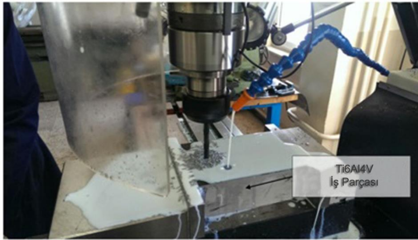
Şekil 44: Ti6Al4V alaşımı üzerinde kesme kuvveti ölçümleri için delik delinmesi işlemi.
