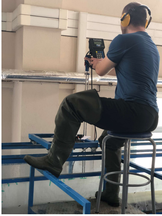
Ek 5. Bartın Üniversitesi hidro-mekanik laboratuvarı Akustik dopler velocity yardımıyla ölçümlerin alınması
