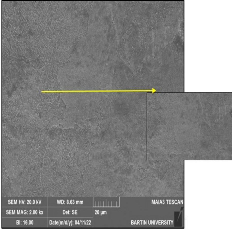
Şekil 24.1: İşlemsiz numune SEM mikroyapı görüntüsü 2000 x.
