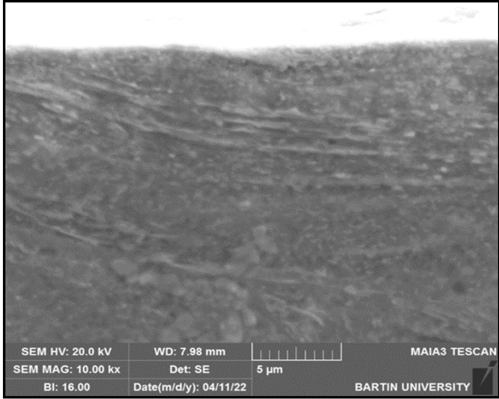
Şekil 42.1: Bilyalı dövülmüş numune SEM yüzey görüntüsü 10000 x.
