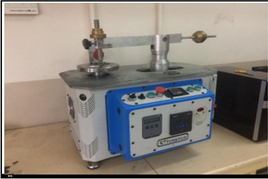
Şekil 20.1: Ball-on-Disk Deney cihazı
