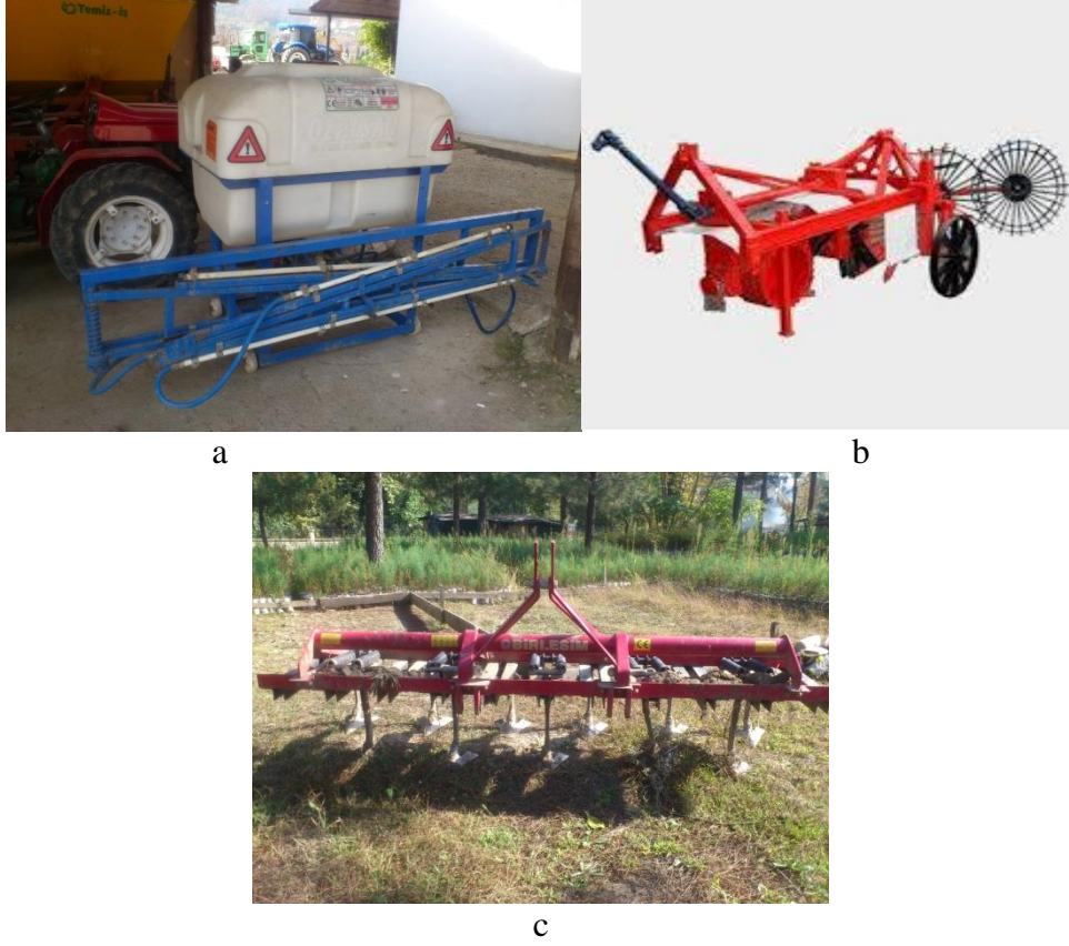
Şekil 4.5. Fidan bakım aşamasında kullanılan pulvarizatör (a), kök seyreltme (b) ve tekleme (c) ekipmanları
