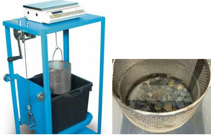
Şekil 4.10: Özgül ağırlık sehpası ve suda tartım aşaması
