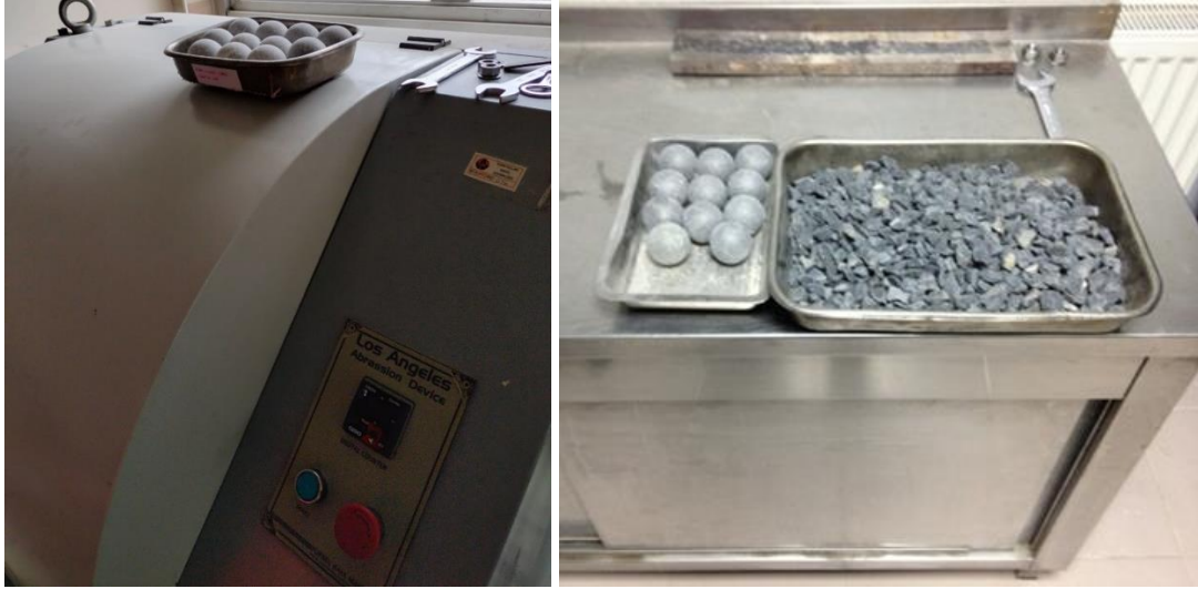
Şekil 4.4: Los Angeles aşınma deneyi aleti ve aşındırma bilyaları
