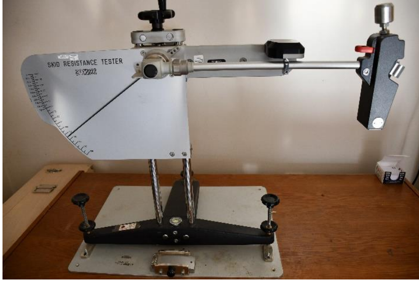
Şekil 4.8: Kayma Direnci Ölçme Cihazı
