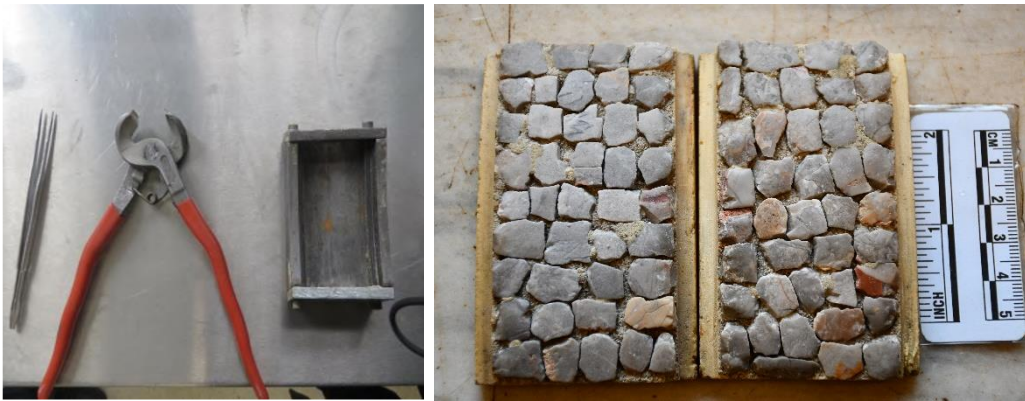
Şekil 4.9: Cilandırma numune kalıbı ve cilandırılmış agrega numune örnekleri
