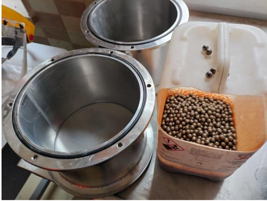
Şekil 4.6: Micro Deval deneyinde kullanılan tambur ve bilyalar
