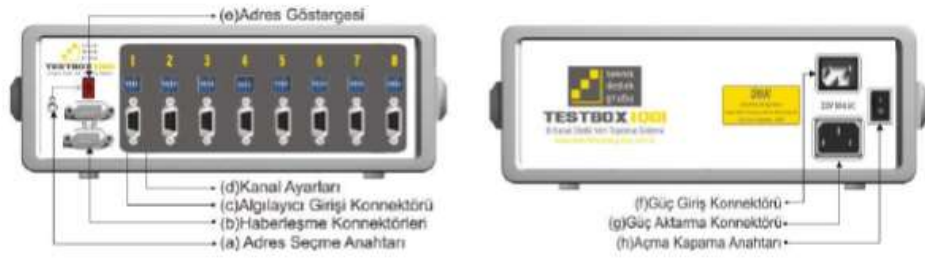
Şekil 3. 13: Veri Toplama Sistemi Ön Panel ve Arka Panel Görünümü.
