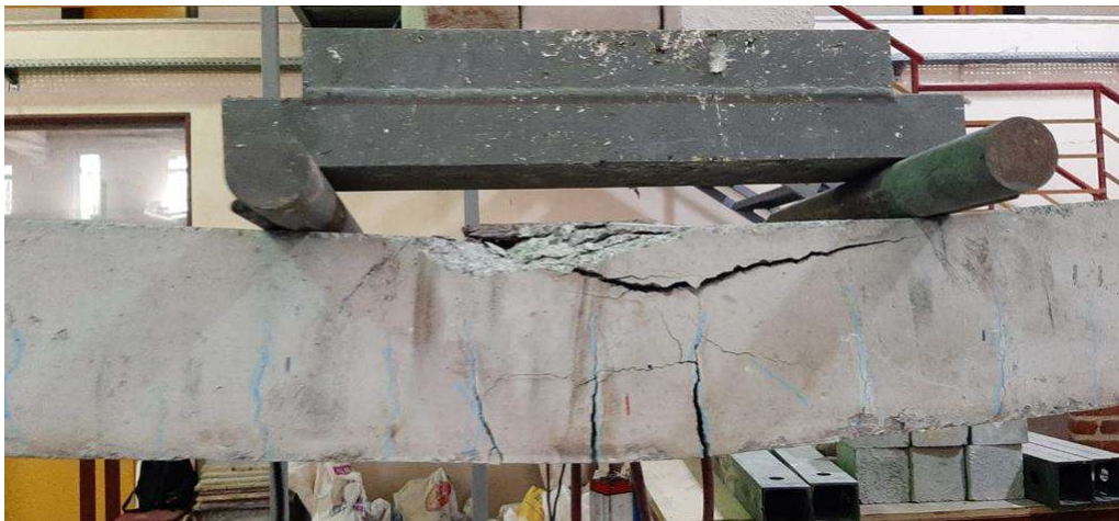
Şekil 4. 11: Deney elemanı-4, 93 mm deplasman altında meydana gelen eğilme çatlakları ve beton ezilmesi
