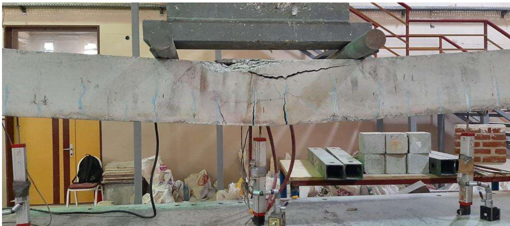
Şekil 4. 9: Deneş elemanı-3 103 mm deplasman altında meydana gelen eğilme çatlakları ve beton ezilmesi
