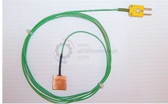
Şekil 3. 16: Termokupl (Isıl Çift-Sıcaklık Sensörü).
