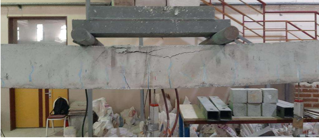
Şekil 4. 4: S1 elemanında meydana gelen eğilme çatlakları ve beton ezilmesi
