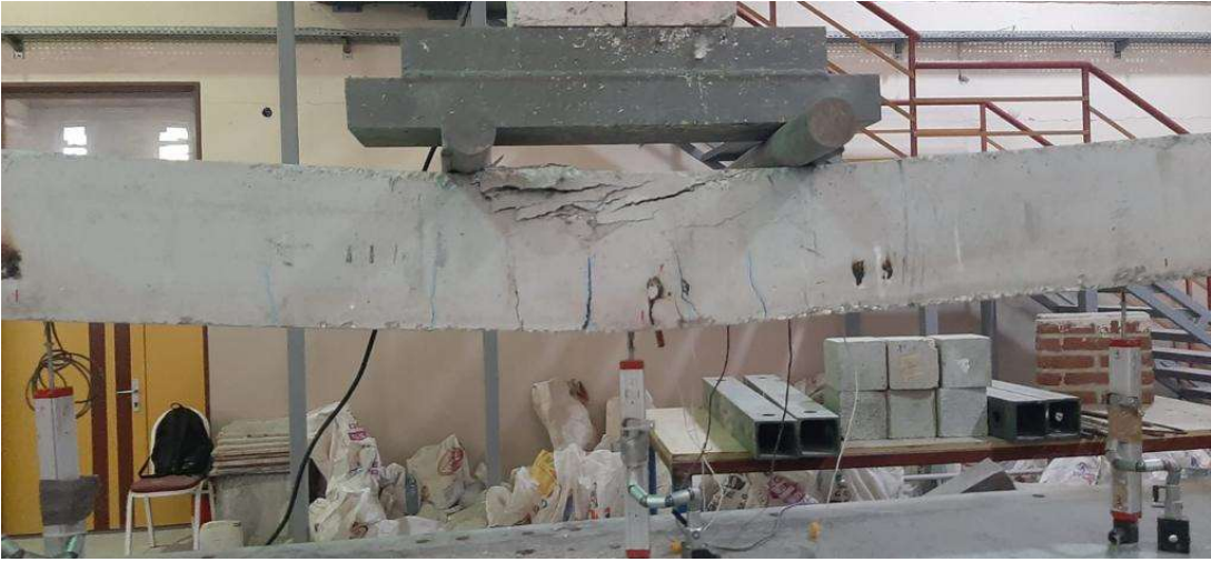
Şekil 4. 5: Deney elemanı-1 100 mm deplasman altında meydana gelen eğilme çatlakları ve beton ezilmesi
