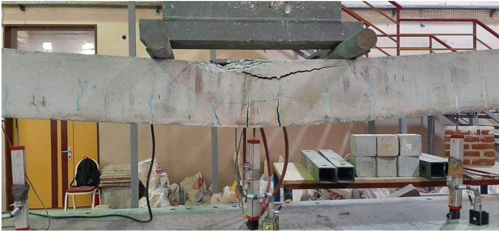
Şekil 4. 7: Deneş elemanı-2 103 mm deplasman altında meydana gelen eğilme çatlakları ve beton ezilmesi
