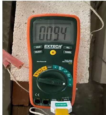
Şekil 3. 9: Deney elemanı-4 için 45. dakika iç ve dış sıcaklık değerleri
