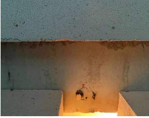
Şekil 3. 10: Numunelerdeki bozulmalar a) Soyulma-toz haline gelme-dökülme b) Su kaybı c) Çatlaklar d) Kararmalar
