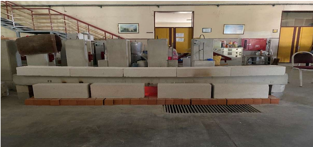
Şekil 3. 11: Numunelerin deney sonunda yerçekimi yönünde hafif eğilmesi
