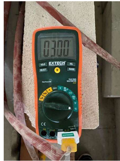
Şekil 3. 8: a) Deney elemanı-3 60. dakikadaki alt yüzey dış sıcaklık değeri b) Deney elemanı-3 60. dakikadaki Termokupl-3'teki iç sıcaklık değeri
