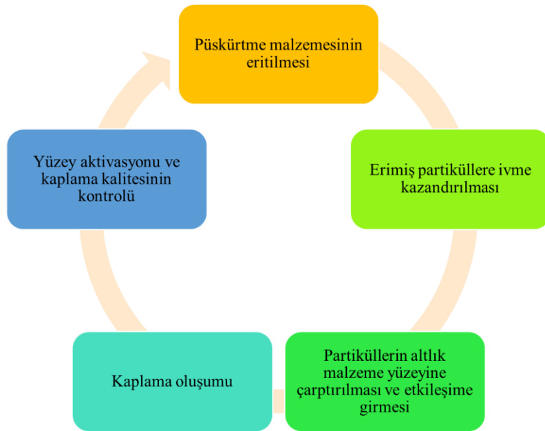
Şekil 2.2: Termal sprey kaplamaların temel işlem adımları
