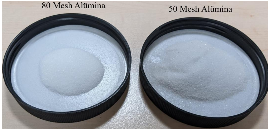
Şekil 4.7: Alümina aşındırıcı partiküllerinin gerçek görüntüleri
