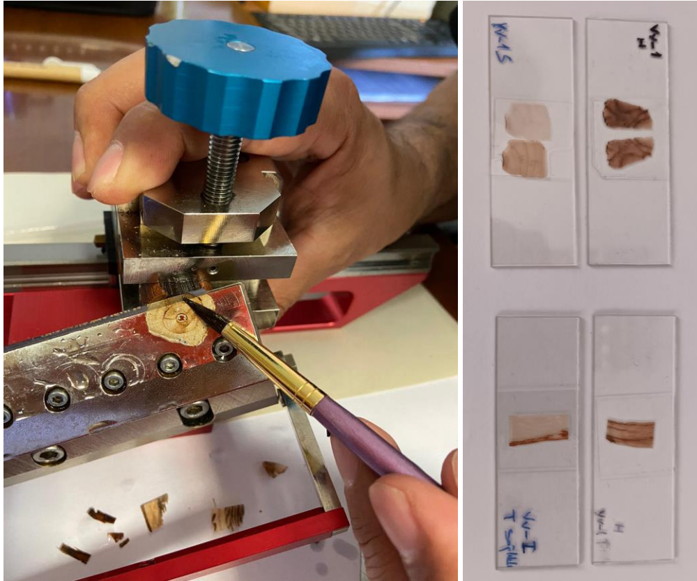
Şekil 2.2: Mikrotomla kesit alımı, hazırlanmış görüle örnekleri
