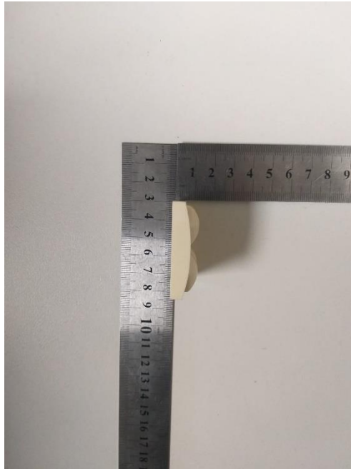
Şekil 4.5: Sinterleme sonrası altıgen geometrili alümina ölçü görüntüleri
