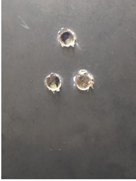
Şekil 4.9: Merminin altıgen geometrili zırha giriş görüntüsü
