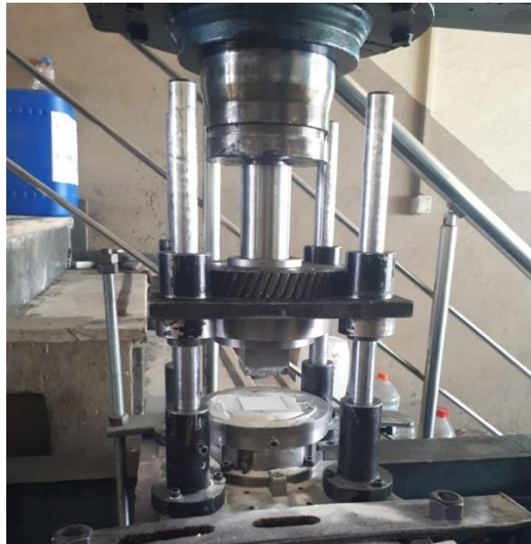
Şekil 3.10: Kalıpların prese bağlanmış hali
