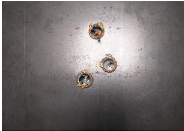
Şekil 4.8: Merminin düz geometrili zırha giriş görüntüsü
