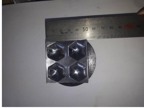
Őekil 3.8: Altıgen kalıbın parlatma sonrasındaki görünüşü
