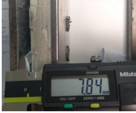
Şekil 4.11: Düz geometrinin balistik test sonrasında açılması
