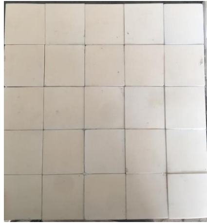
Şekil 3.16: Alümina seramik numunelerin tek çelik zırh plakasına yapıştırılmış hali
