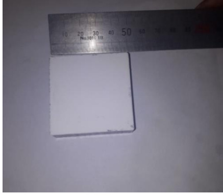
Şekil 4.1: Presleme sonrası düz şekilli alümina numune
