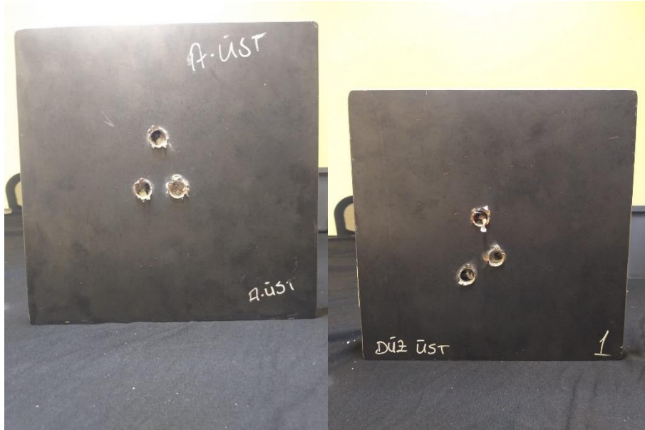
Şekil 4.6: Zırh numunelerine ateş edildikten sonra ön görüntüsü
