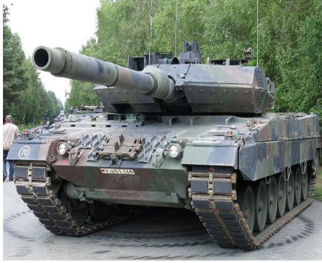
Şekil 1.2: Bor karbür( B_4C ) seramik zırhı kullanılan Alman Leopard 2A7 tankları.(URL-1 2022)
