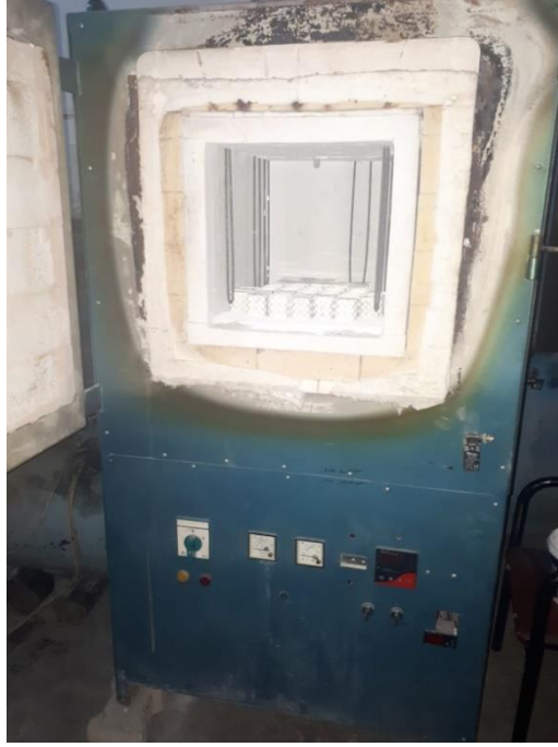
Şekil 3.12: Seramiklerin sinterlendiđi fırın
