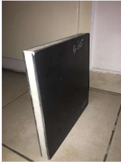
Şekil 3.17: Zırh numunenin birleştirildikten sonraki hali
