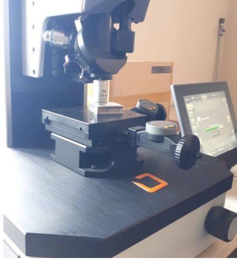
Şekil 3.14: Seramik numuneye sertlik testi uygulanma anı
