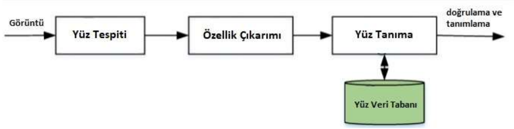
Şekil 2.3: Yüz tanıma sistemlerinin yapısı. (Kortli vd., 2020)
