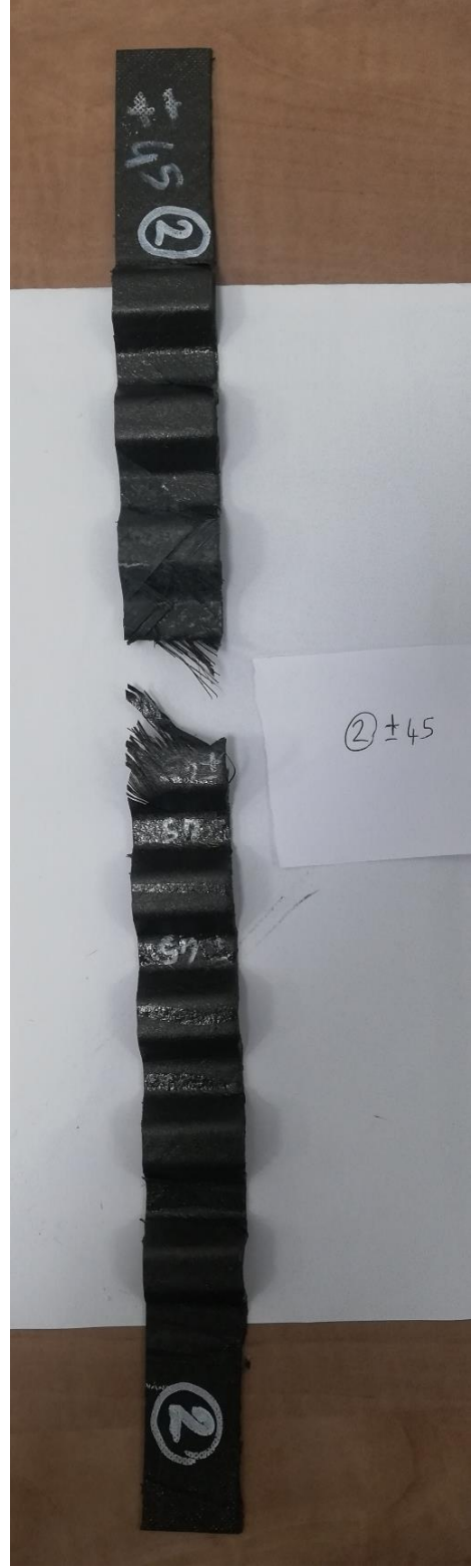
Şekil 15.3: \pm 45 Derece 2. Numune Test Sonrası
