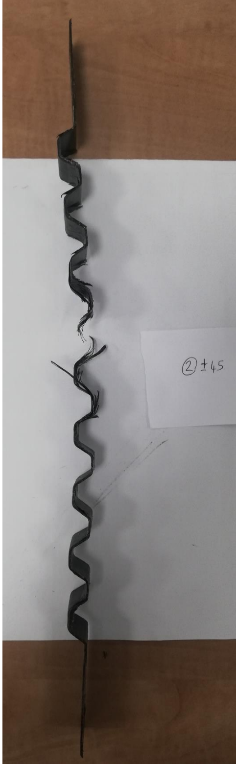
Şekil 15.3: \pm 45 Derece 2. Numune Test Sonrası
