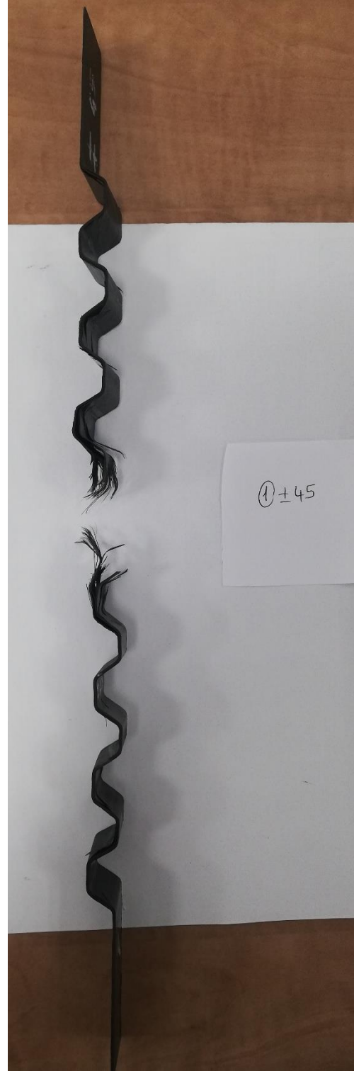
Şekil 15.2: \pm 45 Derece 1. Numune Test Sonrası
