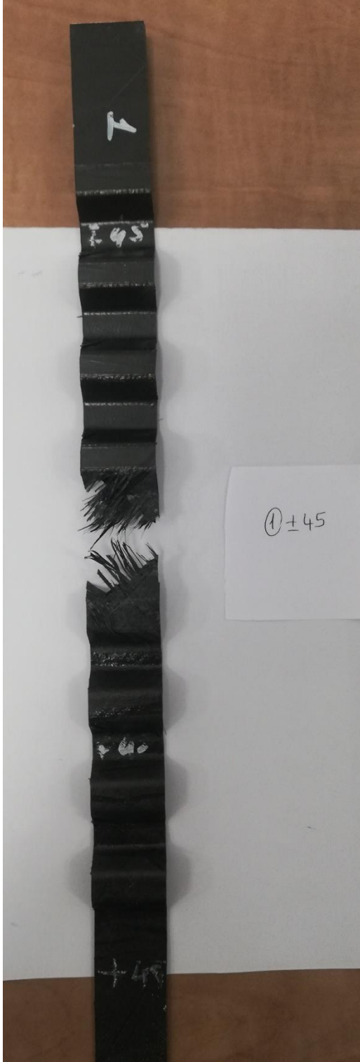
Şekil 15.2: \pm 45 Derece 1. Numune Test Sonrası
