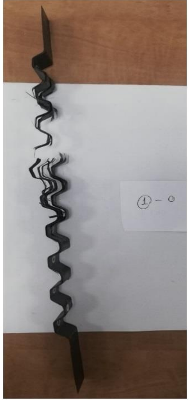
Şekil 15.1: 0 derece 1. Numune, Test Sonrası, Ön ve Yan görünüş
