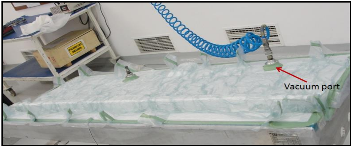
Şekil 10.6: Vakum port ile ara vakuma alınan bir kalıp
