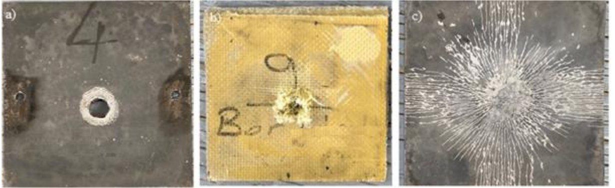
Şekil 4.5: ZM-4 zırh modelinde atış sonrası oluşan hasar görüntüleri a) borlanmış çelik (B) b) çift katman kevlar plaka (K+K) c) borlanmış çelik (B)
