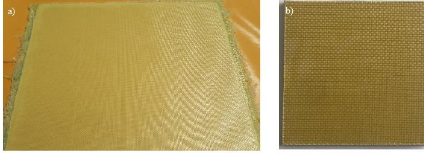
Şekil 3.1: Kevlar plaka üretimi a) kumaş ve reçine uygulaması b) sıcak presleme sonrası kesilerek hazırlanan kevlar zırh katmanı.
