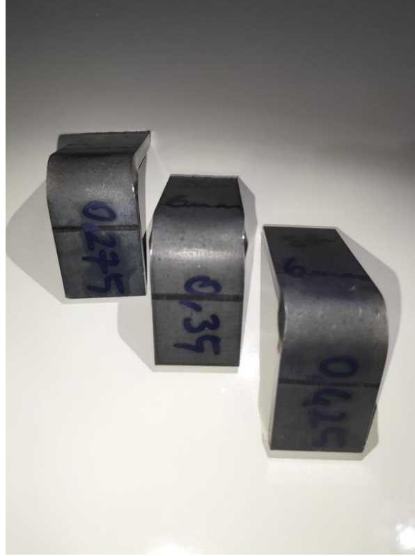
Şekil 4.12: 6 mm St37 sacının 0,275-0,350-0,425 k-faktörlerine göre bükümleri
