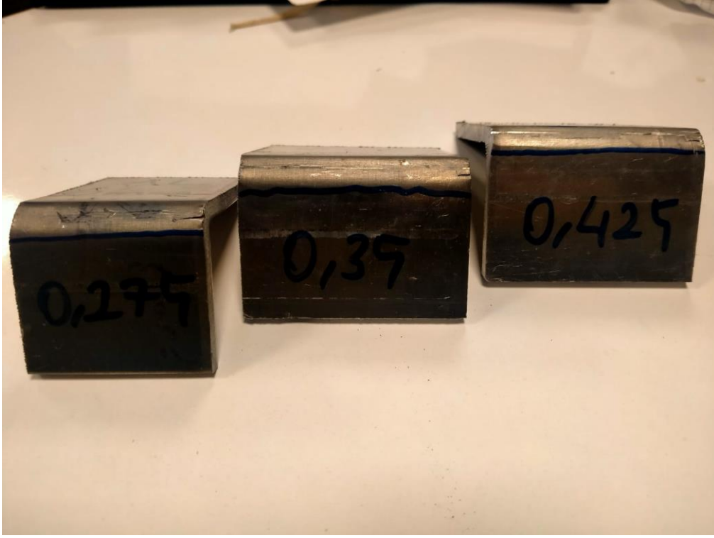
Şekil 4.8: 6 mm Alüminyum5754 – H111 sacının 0,275-0,350-0,425 k-faktörlerine göre bükümleri
