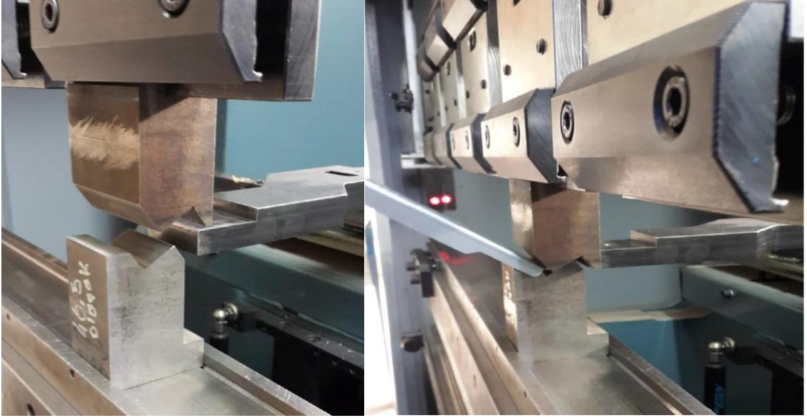
Şekil 1.7: 90^\circ lik birden fazla bükümün tek seferde uygulanması
