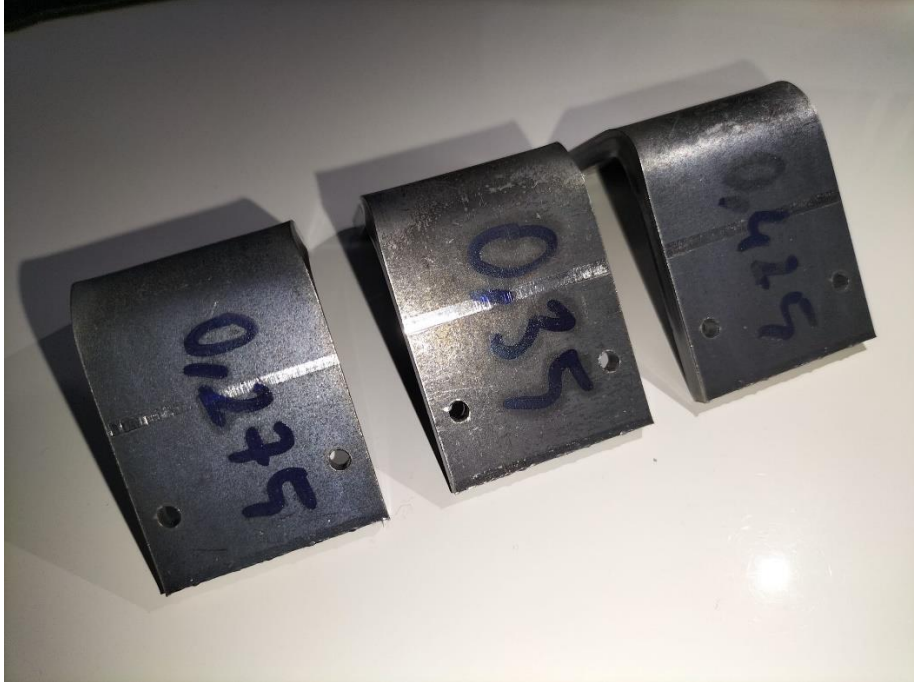
Şekil 4.11: 5 mm St37 sacının 0,275-0,350-0,425 k-faktörlerine göre bükümleri
