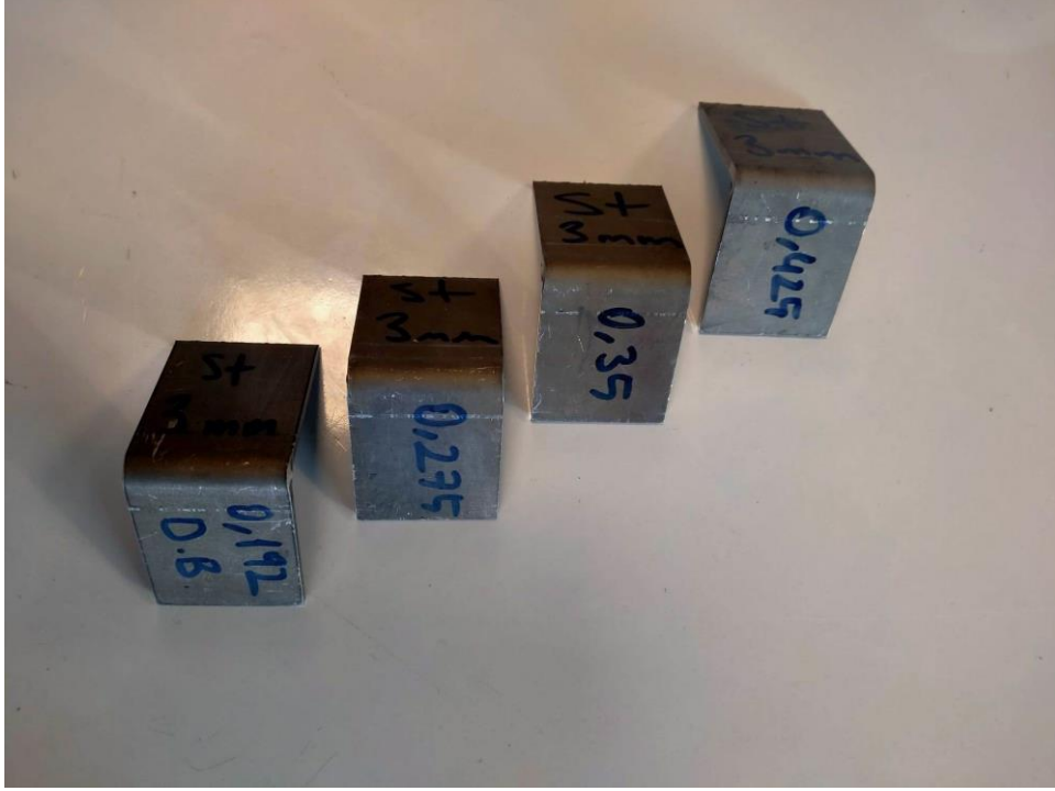
Şekil 4.10: 3 mm St37 sacının doğrulama bükümü olan 0,192 ve 0,275-0,350-0,425 k-faktörlerine göre bükümleri
