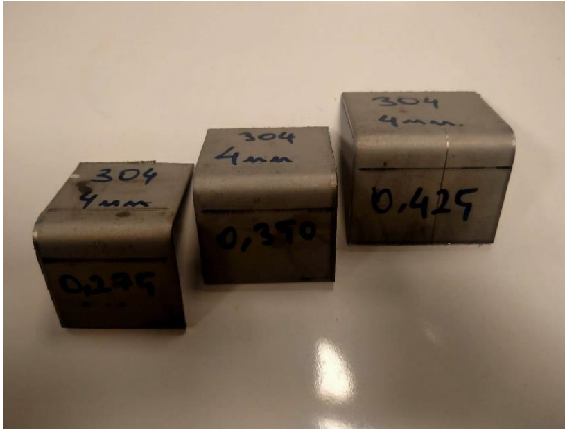
Şekil 4.5: 4 mm AISI 304 kalite paslanmaz çeliğinin 0,275-0,350 ve 0,425 k-faktörlerine göre bükümleri
