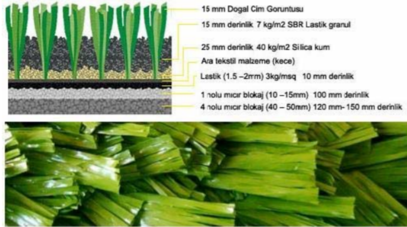
Şekil 2. 3. Polyethylene sentetik çim zeminlerden bir kesit
