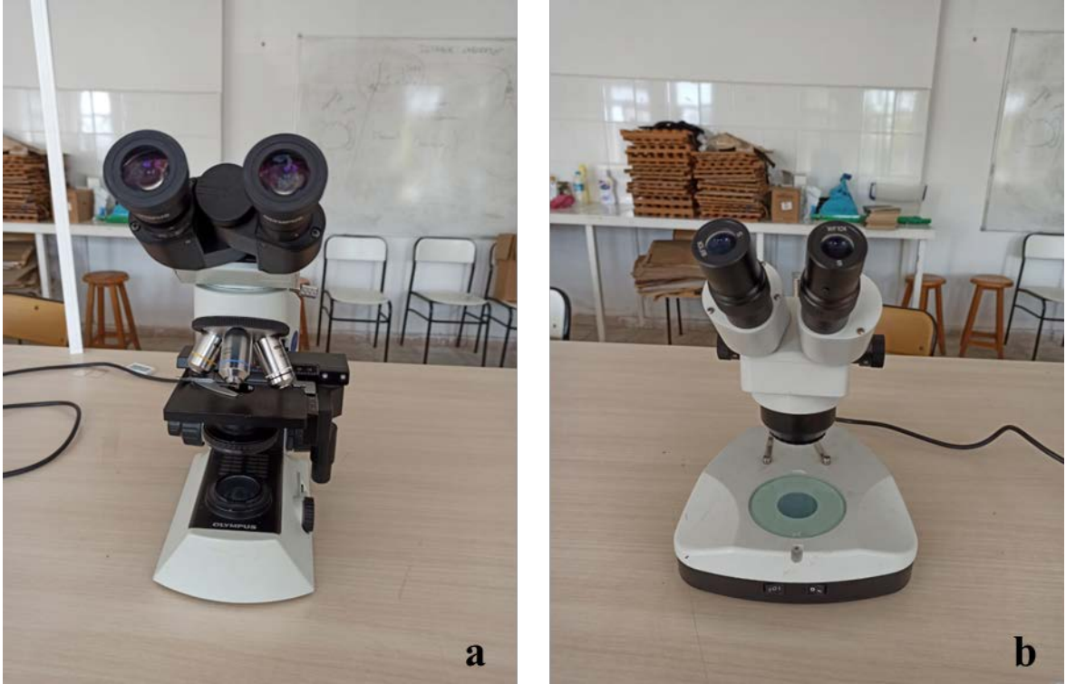
Şekil 3.1: Tez çalışmasında kullanılan ışık mikroskobu (a) ve stereo mikroskop (b)
