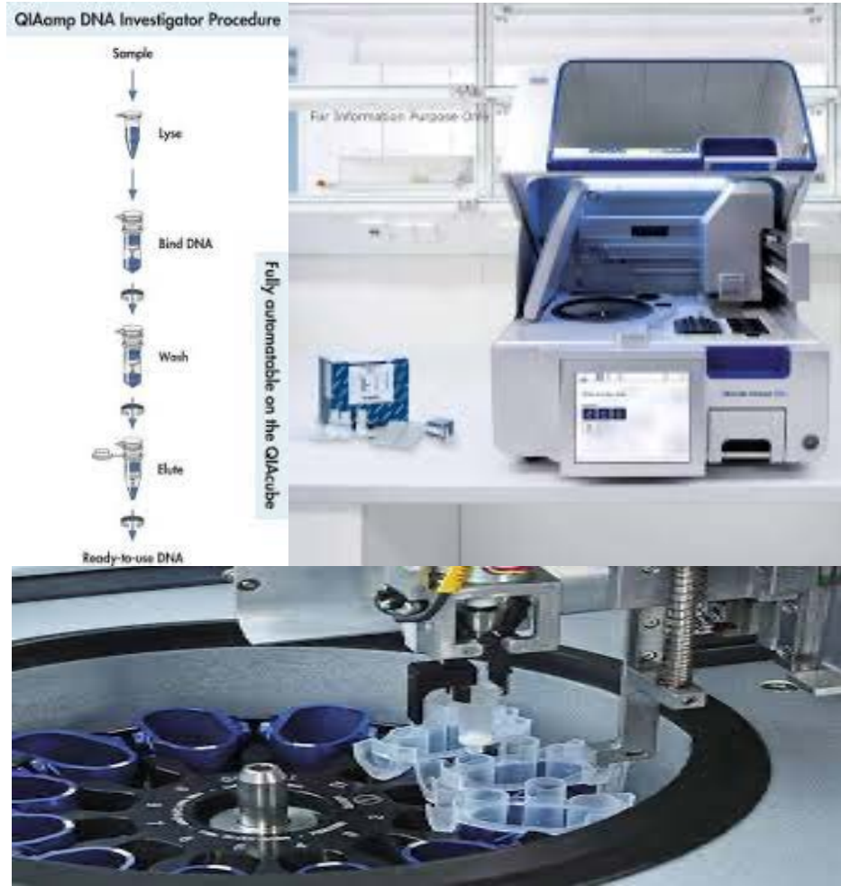
Şekil 3.2: QIAcube Lt otomatik izolasyon robotu ve bitkilerden DNA izolasyonu
