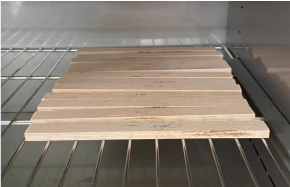
Şekil 3.9: Denge rutubetine getirilen eğilme deneyi örnekleri (Fotoğraf: Engin ŞAHİN, 2022)
