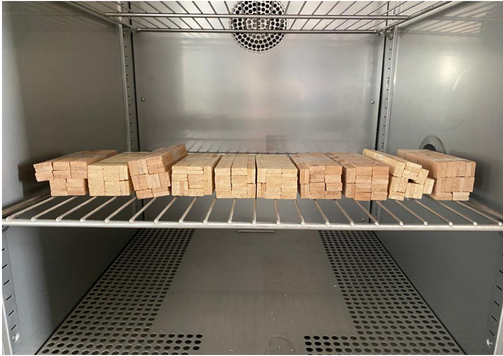
Şekil 3.6: Denge rutubetine getirilen çekmede makaslama deneyi örnekleri (Fotoğraf: Engin ŞAHİN, 2022)
