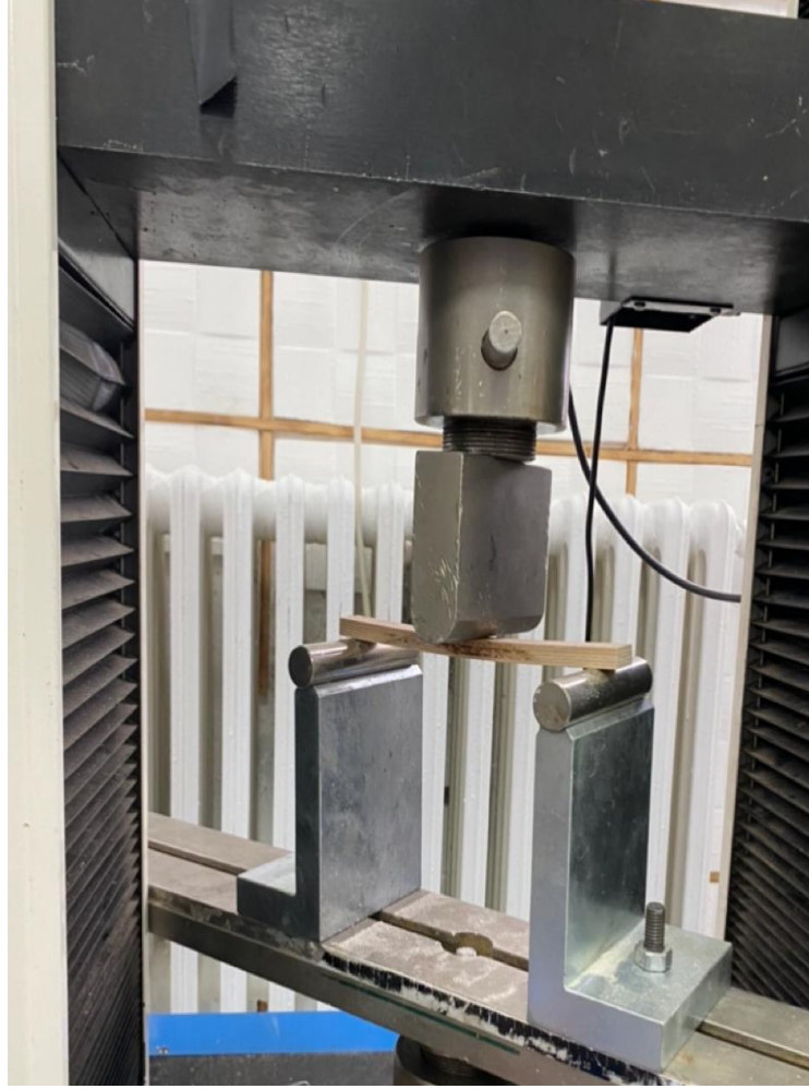
Şekil 3.11: Eğilme deneyi uygulaması (Fotoğraf: Engin ŞAHİN, 2022)
