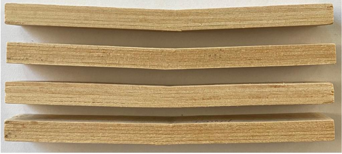
Şekil 4.6: Nanokil katkılı sıvı deri tutkalı ile hazırlanan kayın LVL numunelerinin test sonrası görünümü (Fotoğraf: Engin ŞAHİN, 2022)
