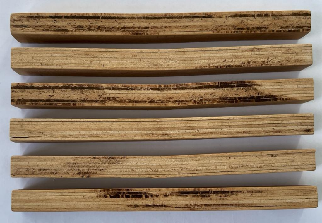
Şekil 4.7: Boncuk tutkalı ile hazırlanan kayın LVL numunelerinin test sonrası görünümü (Fotoğraf: Engin ŞAHİN, 2023)
