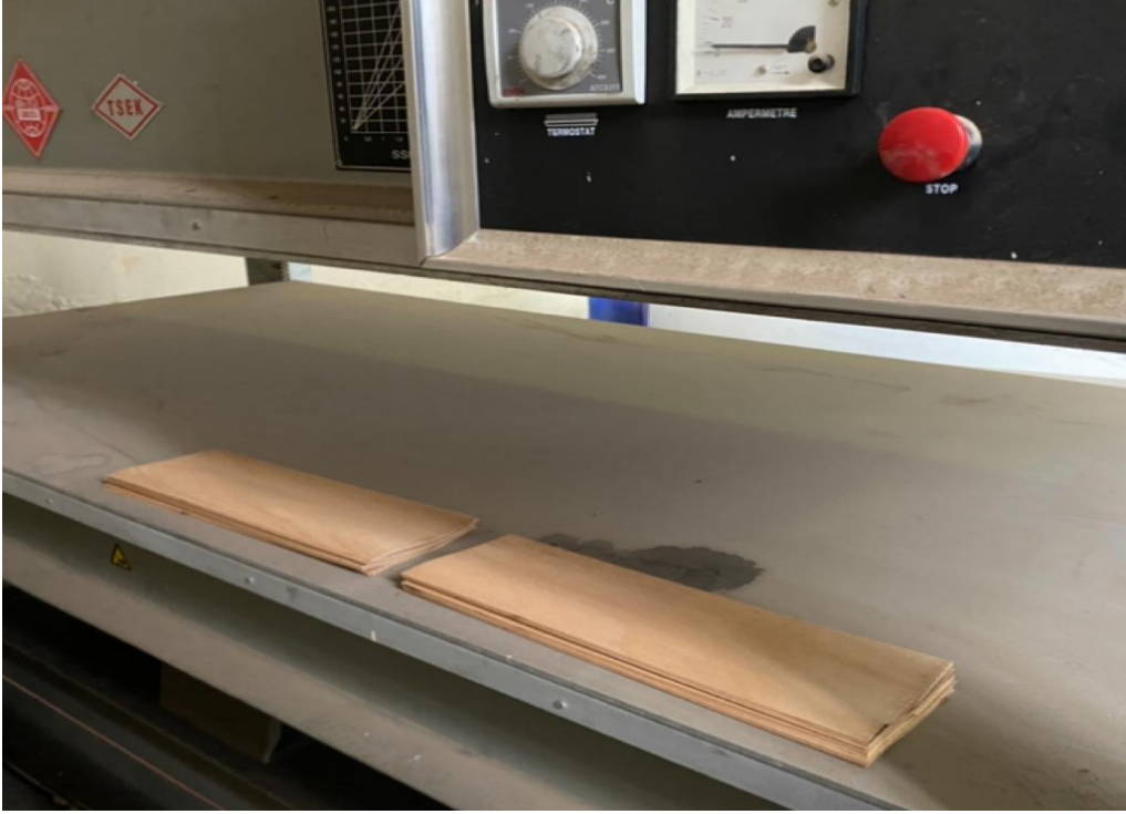
Şekil 3.8: Presleme işlemi (Fotoğraf: Engin ŞAHİN, 2022)
