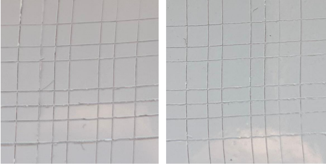
Şekil 5.2: a) Demir Fosfat kaplı DKP numune b) Zirkonyum kaplı DKP numune
