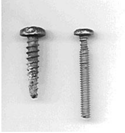
Şekil 2.7: Paslanmaz çelik civatada oluşan çatlak korozyonu (URL-7, 2024)
