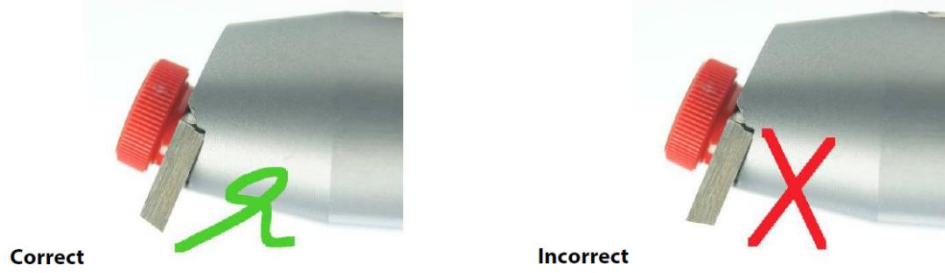
Şekil 4.10: Cross-cut testi bıçak pozisyonu
