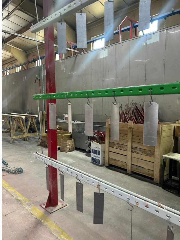
Şekil 4.4: Konveyör bandına asılan deney numuneleri
