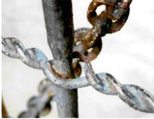
Şekil 2.16: Aşındırma korozyonuna uğramış çit direği (URL-7, 2024).
