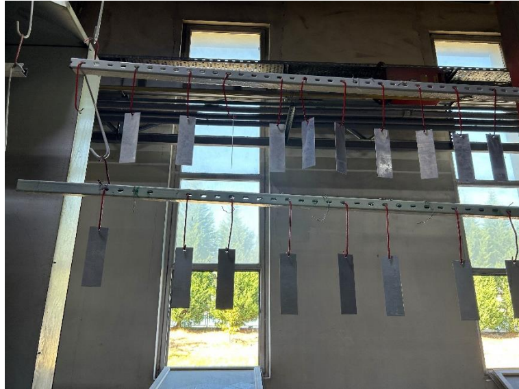
Şekil 4.7: Elektrostatik toz boya kaplama için konveyöre asılan parçalar
