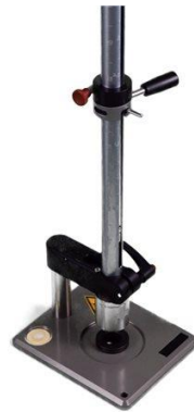
Şekil 4.15: EN ISO 6272-1 Darbe Testi
