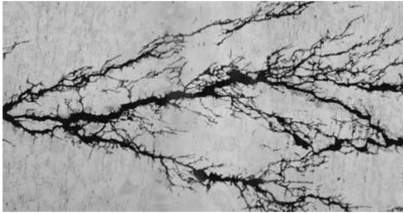
Şekil 2.14: Gerilmeli korozyon (URL-7, 2024).
