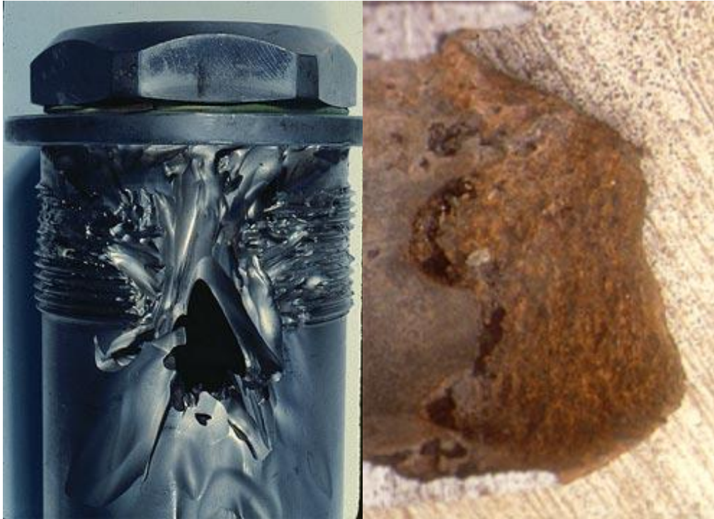
Şekil 2.13: Petrol sahası kontrol vanası ve iletim borusunde oluşan erozyon korozyonu (URL-7, 2024).
