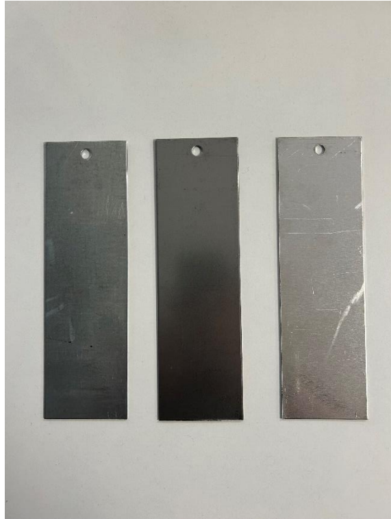
Şekil 4.3: Deneysel çalışma yapılacak numuneler 1) Pregalveniz 2) DKP 3) Alüminyum
