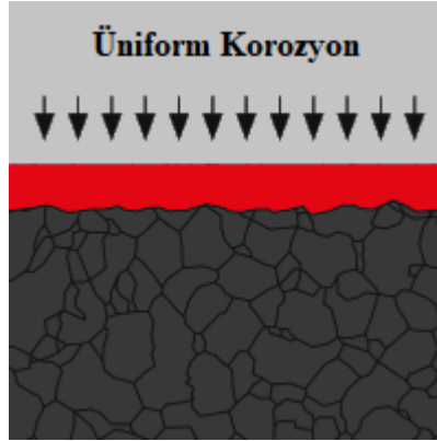
Şekil 2.2: Üniform korozyon (URL-6, 2024).
