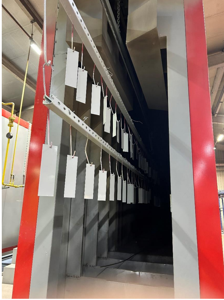
Şekil 4.9: K rlenmiŐ Őekilde fırından ıkan paralar
