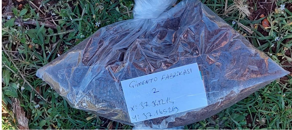
Şekil 2.6 Toprak numunelerinin alınması, paketlenmesi ve adlandırılması. (Çimento Fab.)
