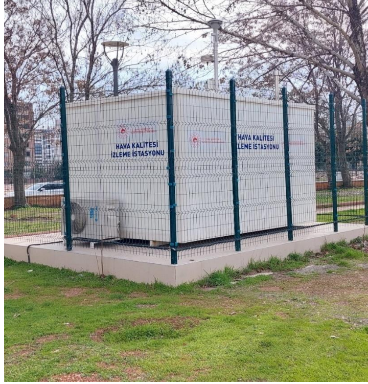
Şekil 0.1 Kahramanmaraş Necip Fazıl Kısakürek Kültür Merkezi bahçesinde bulunan merkez hava kalitesi izleme istasyonu
