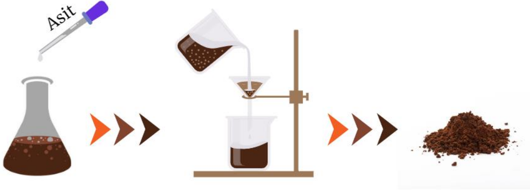
Şekil 3.2: Ligninin asitle çöktürme yöntemiyle siyah çözeltilerden ayrılması
