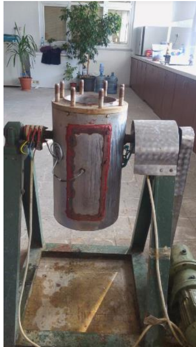
Şekil 3.1: Laboratuvar tipi pişirme kazanı (Fotoğraf: Esra Ceylan, 2018) 700 gr tam kuru yonga ile Tablo 3.1’de belirtilen deney planına bağlı kalınarak kraft pişirme
