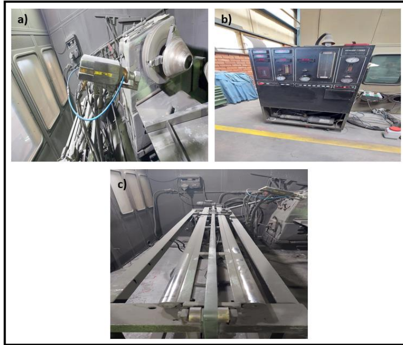
Şekil 3.4: HVOF kaplama yöntemine ait gerçek cihaz görünümü; (a) kaplama tabancası, (b) toz besleme ve gaz ünitesi, (c) tabanca hareket kazağı
