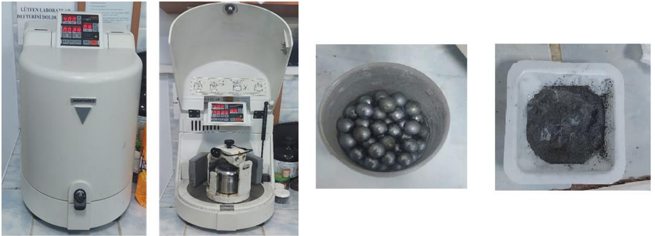
Şekil 3.5: Pulverisette-6 MA Cihazı, WC bilyeler ve metalik tozlar
