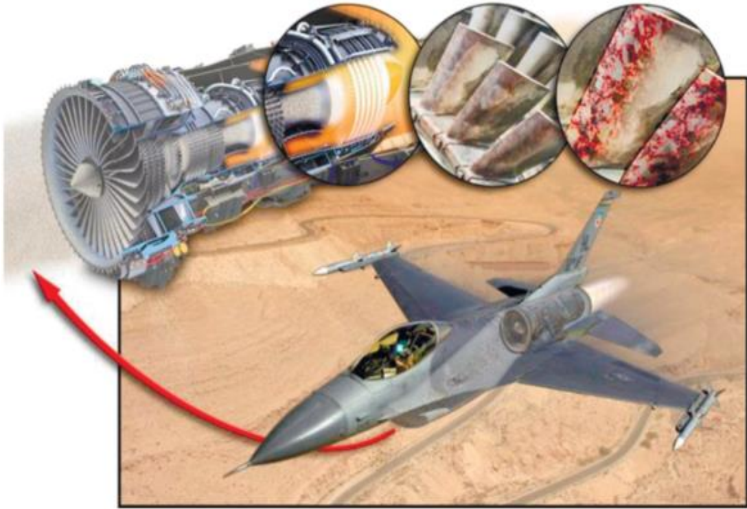
Şekil 2.20: Katı partikül erozyon hasarına uğramış gaz türbin kanadı (Prashar vd., 2023).
