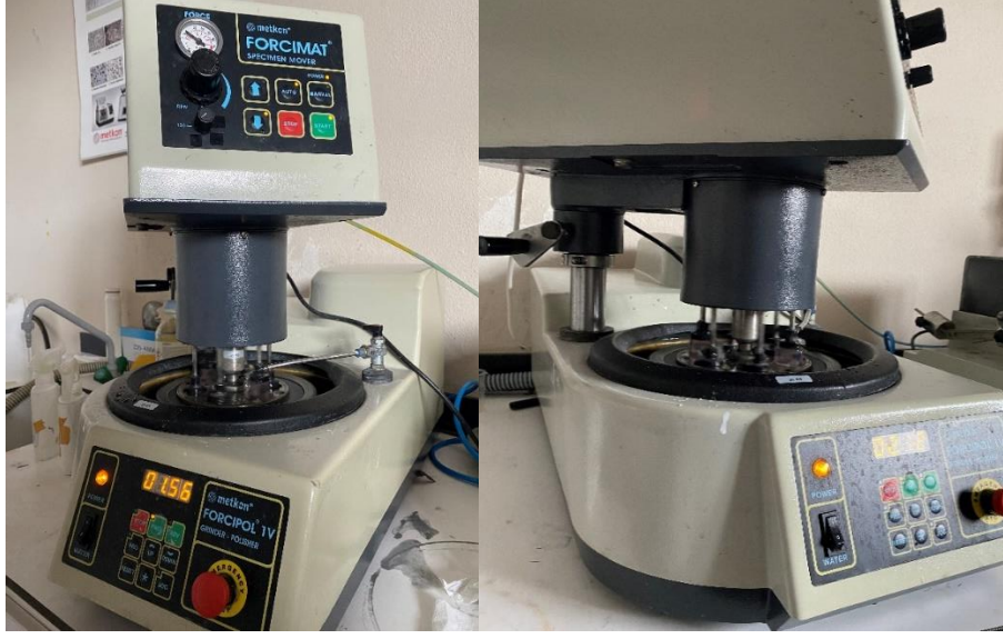
Şekil 3.3: Metcon Forcıpöl IV marka zımparalama ve parlatma işleminin cihazı.
