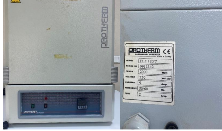
Şekil 3.1: Protherm marka İzotermal oksidasyon ve sıcak korozyon deneylerinin gerçekleştirildiği yüksek sıcaklık fırını.
