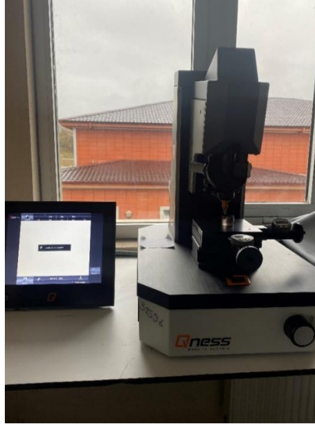
Şekil 3.2: QNESS marka vickers sertlik ölçüm cihazı.
