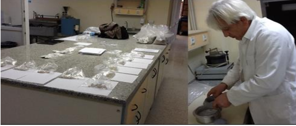
Şekil 3: ICP 50 µm boyutunda numune hazırlama işlemi
