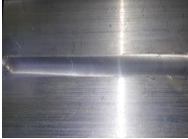
Şekil 3: Kaynak sonrası ön dikiş görünümü
