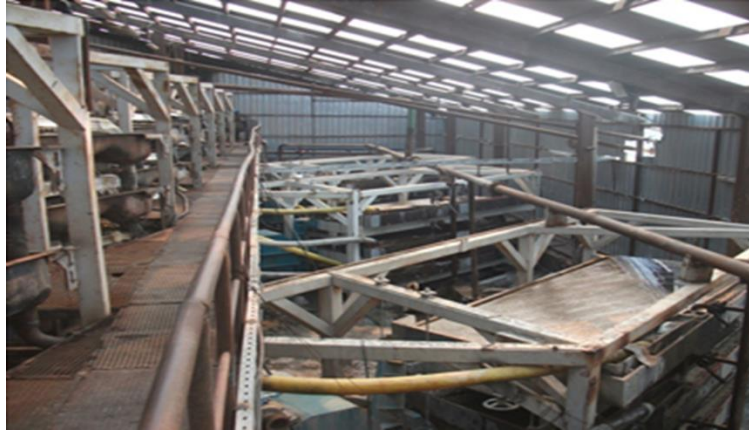
Şekil 2 Erzurum-Krom cevheri Sallantılı Masa ile Zenginleştirme[16].
