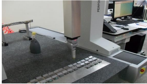
Şekil 3: CMM ile geri esnemenin ölçümü
