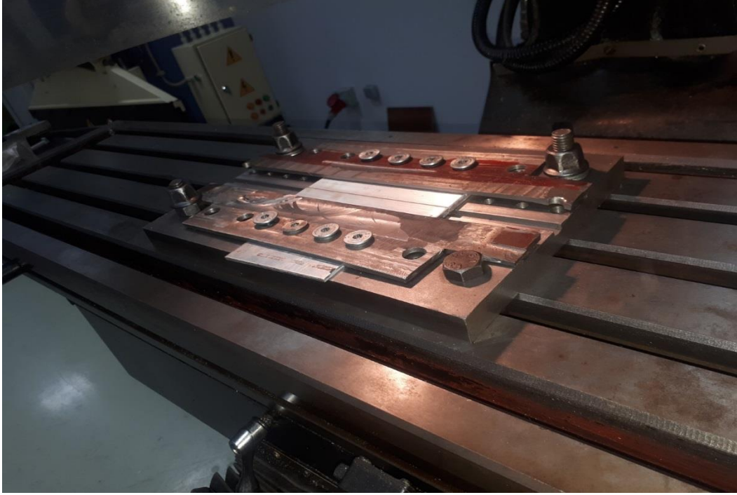
Şekil 1: Kaynak parçalarının kalıba bağlanması
