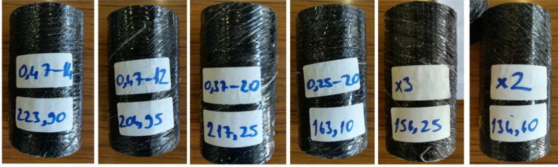
Şekil 3: Üretilen çarpışma kutuları (Üsteki etiket numune adı, alttaki etikette ise ağırlık yazmaktadır.)
