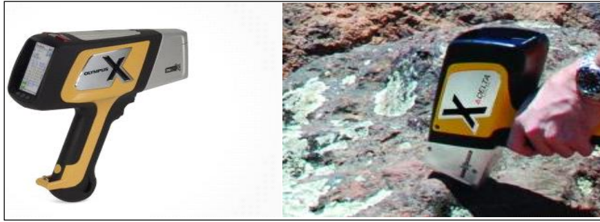
Şekil 4: Portatif XRF elementel kimyasal analiz cihazı.
