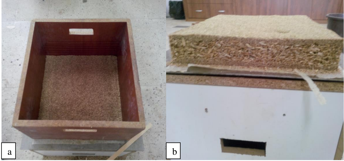
Şekil 48: a.Yongaların serilmesi, b. Levha taslağı.
