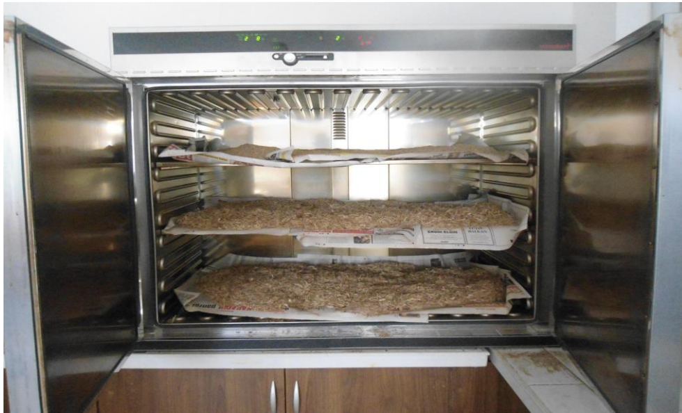
Şekil 46: Yongaların etüvde kurutulması.
