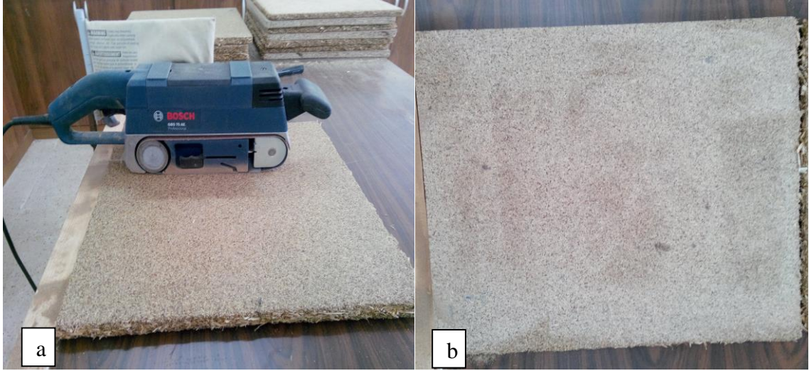
Şekil 51: a: Levhaların zımparalanması, b: Zımparalanmış levha yüzeyi.
