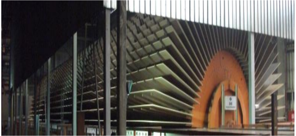
Şekil 41: Yonga levhaların yıldız soğutucuda dinlendirilmesi (URL-8, 2015).
