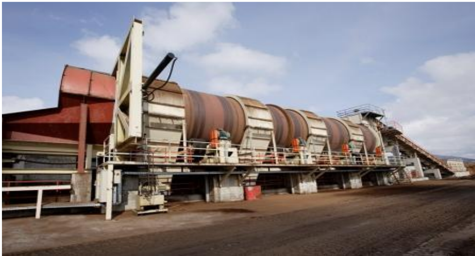
Şekil 24: Döner tamburlu kabuk soyucu (Biçer, 2014)
