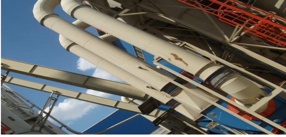
Şekil 33: Havalı (Pnömatik) taşıyıcı (Biçer, 2014).
