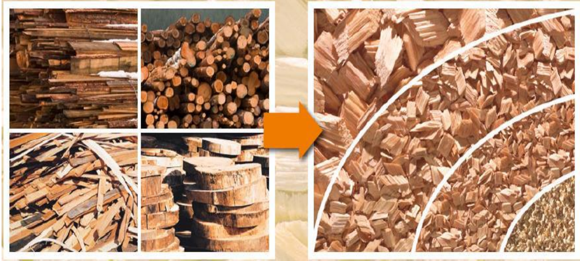
Şekil 25: Odundan ve diğer sanayi atıklarından elde edilen yongalar (URL-8, 2015).
