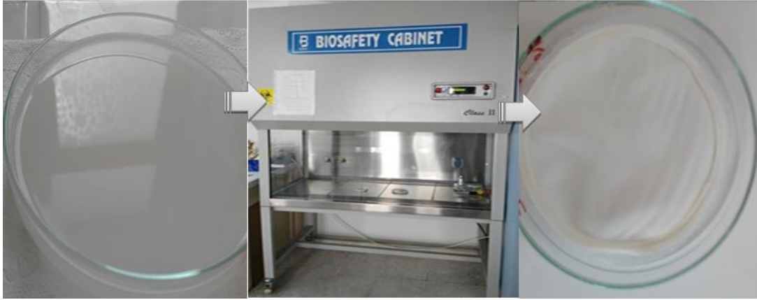
Şekil 21: Karışımın petri kabına dökülmesi, çeker ocağa bırakılması ve kuruması.
