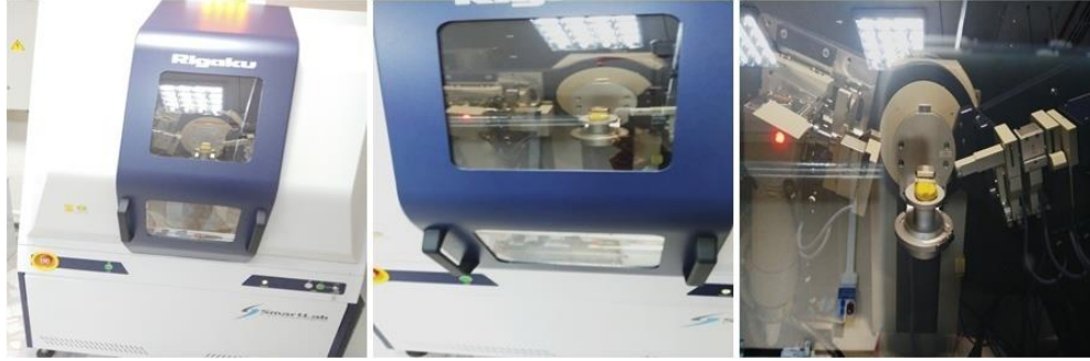
Şekil 25: XRD cihazına örnek yerleştirilmesi.
