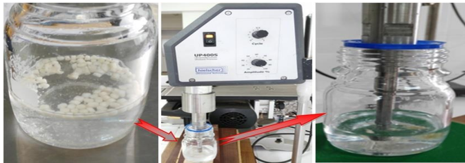
Şekil 19: AC partikülü içeren kloroformun ultrasonik karıştırma işlemi.
