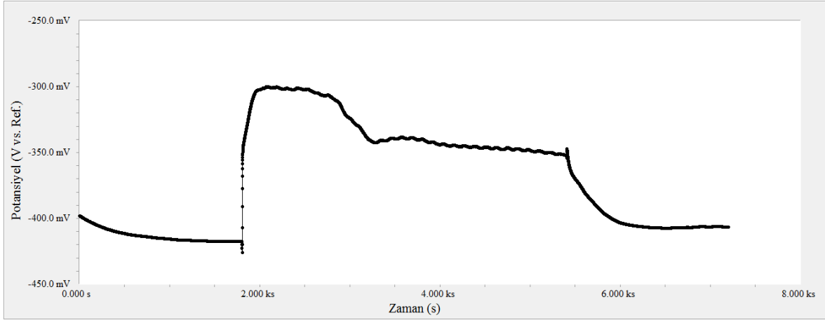
Şekil 8.9: 5N yük altında AISI 4140 altlık malzemenin açık devre potansiyeli.
