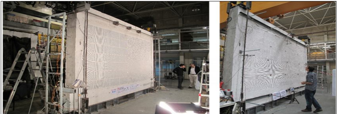
Şekil 38: Deney için kullanılan örme duvar (Ramosa, 2015).
