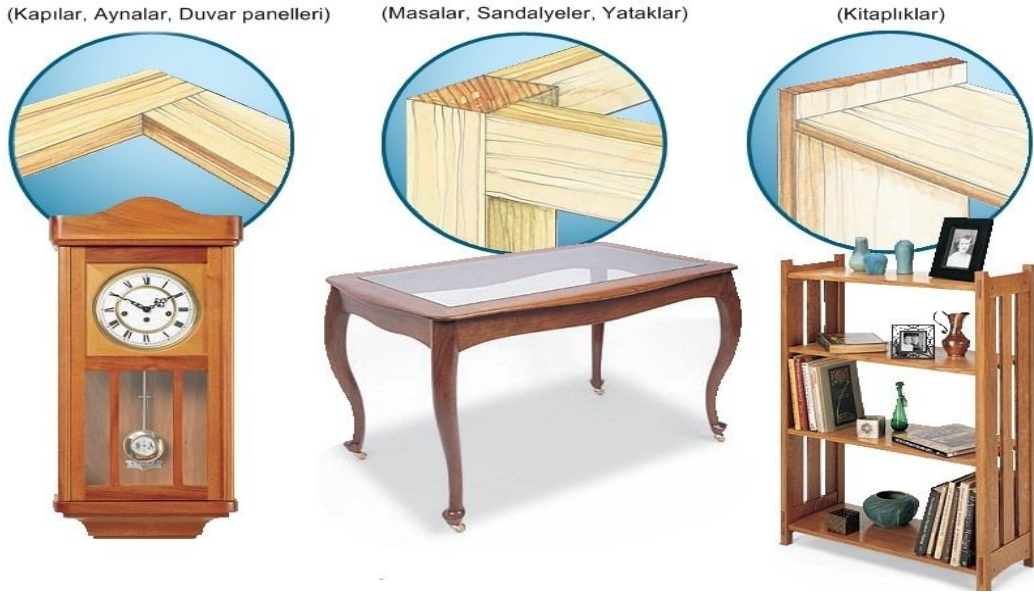
Şekil 15: Lamba zıvanalı birleştirmelerin farklı kullanım alanları (Kirby, 2001).
