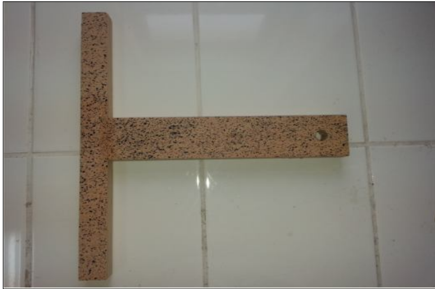
Şekil 55: Gerinim ve deformasyon alanlarını belirlemek için oluşturulan stokastik desen.
