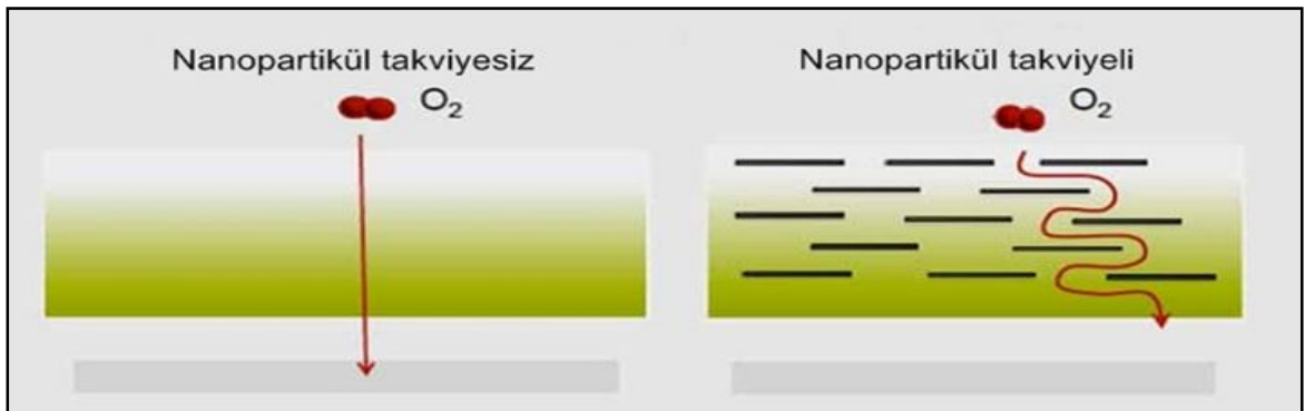
Şekil 85: Nanopartikül takviyeli polimer ile takviyesiz polimerin difüzyon yolu (Silvestre ve Duraccio, 2011).
