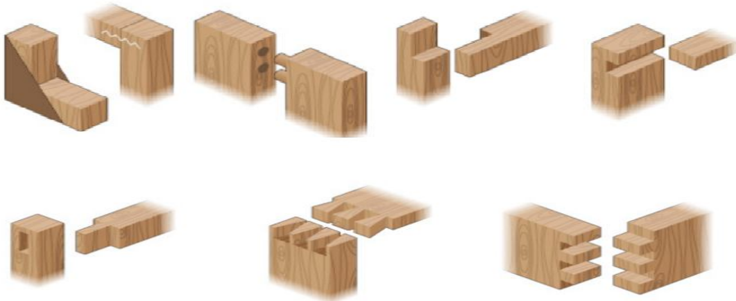
Şekil 14: Ahşap mobilya üretimde yaygın olarak kullanılan birleştirmeler (URL-4, 2015).
