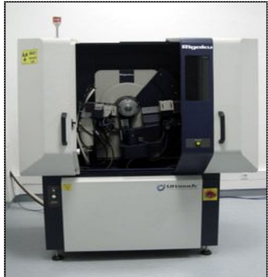
Şekil 41: XRD analizi için hazırlanan numuneler ve XRD cihazı.
