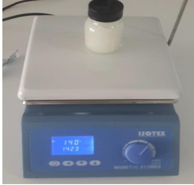
Şekil 13: Çalışmada kullanılan PHB'nin kloroform içinde çözdürülmesi.
