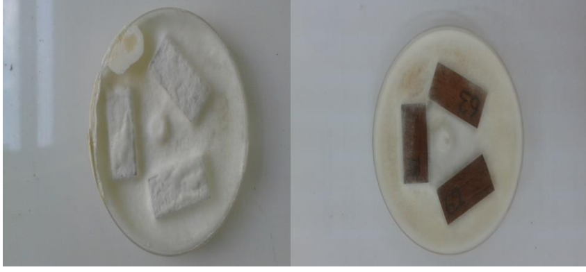
Şekil 7: Kontrol - Emprenye + Isıl işlem örnekleri.
