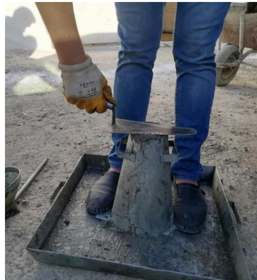
(b) Betonun mastarlanması
