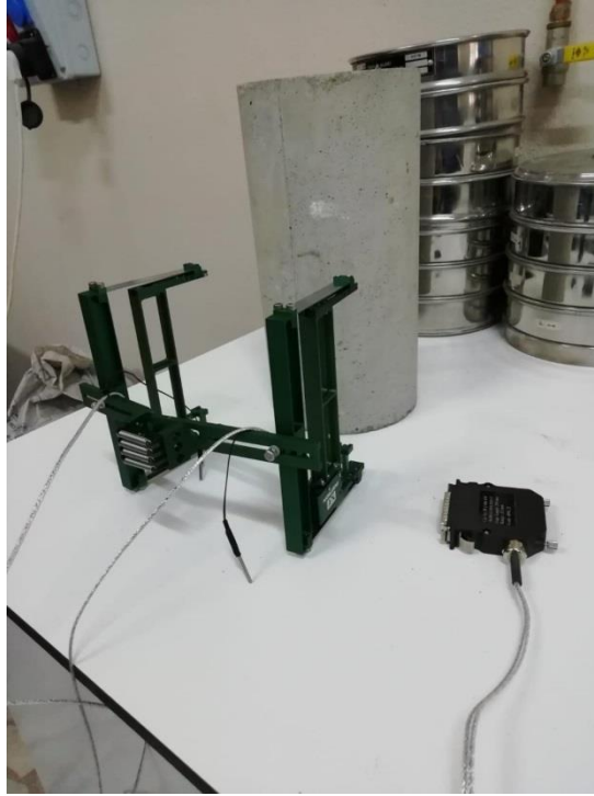
Şekil 3.12: Betonda elastisite modülü deneyi.
