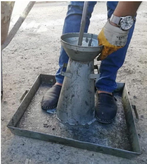
(a) Betonun şişlenmesi
